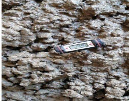
Figura 12. Temperatura del concreto
