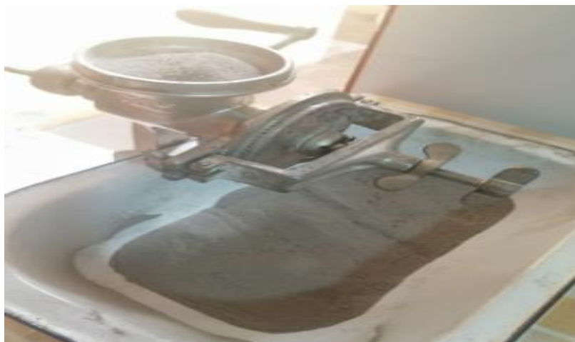
Figura 22. Proceso de molino manual de ceniza de rastrojo de paprika
