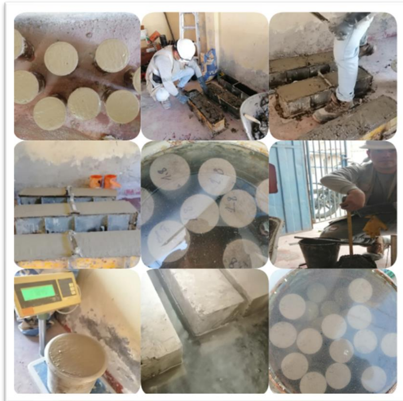
Fotografía 10: Preparación de especímenes de concreto, vigas de 15x15x70 cm Curado de probetas v vigas
