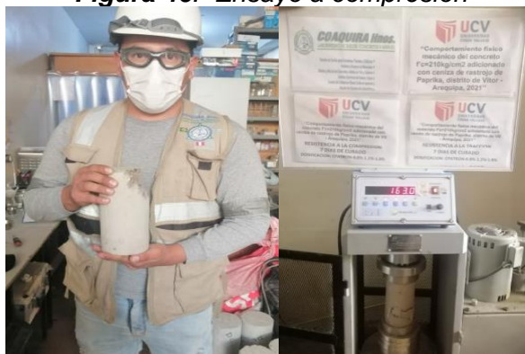
Figura 46. Ensayo a compresión
