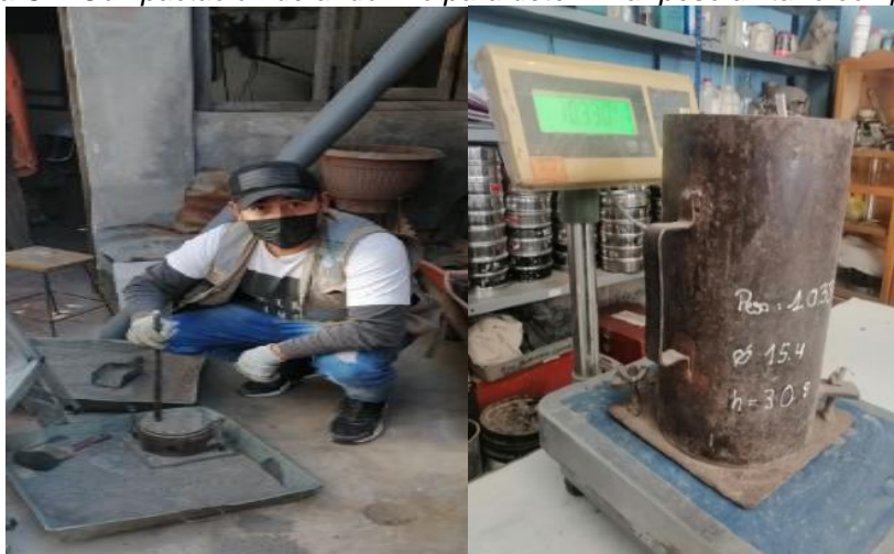
Figura 34. Compactación de árido fino para determinar peso unitario compactado
