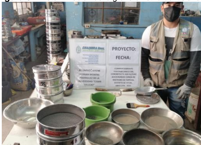
Figura 31. Determinación de la granulometría de los áridos
