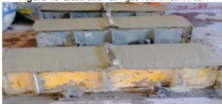
Figura 45. Elaboración de vigas 15cmx15cmx70cm
