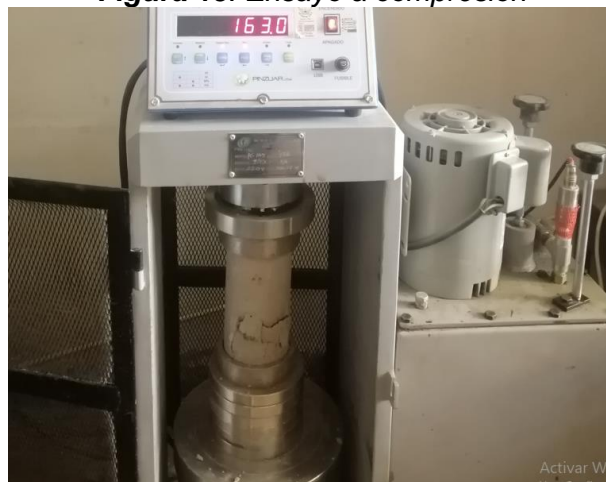
Figura 15. Ensayo a compresión
