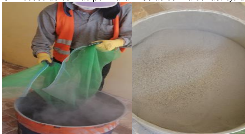
Figura 23. Proceso de cernido por malla N°50 de ceniza de rastrojo de paprika
