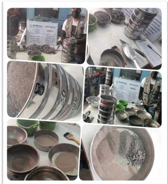
Fotografía 6 Granulometría de los agregados
