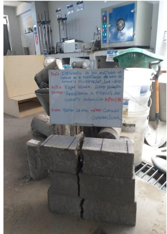
Fotografía 28. Rotura de Vigas
