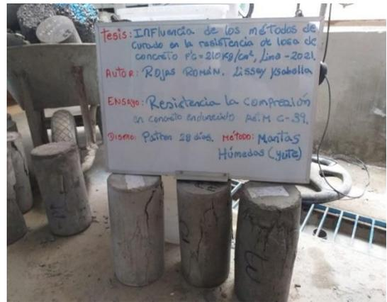
Fotografía 16. Rotura de testigos a compresión. curados con Yute.
