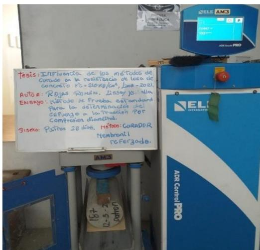
Fotografía 23. Curado con aditivo -tracción
