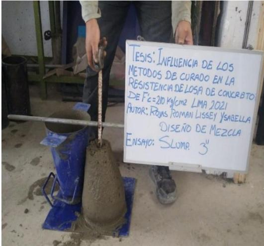
Fotografía 7. Ensayo de slum
