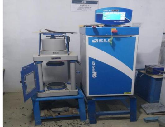
Fotografía 2. Prensa Hidráulica
