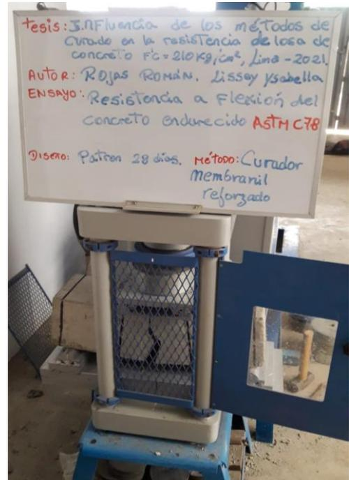
Fotografía 26. Ensayo a flexión
