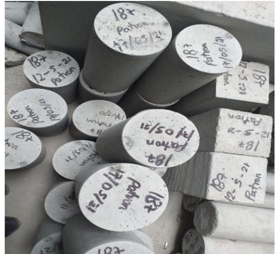
Fotografía 8. Testigos de concreto
