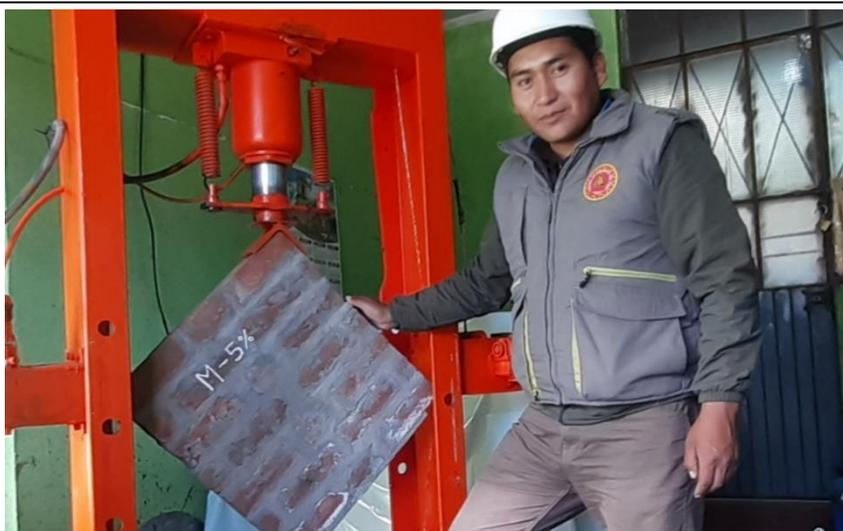
**Descripción:** Vista donde se aprecia el ensayo de resistencia a corte (compresión diagonal) de muretes de ladrillos artesanales incorporando ceniza de totora en diferentes porcentajes (5%, 10% y 15%).
