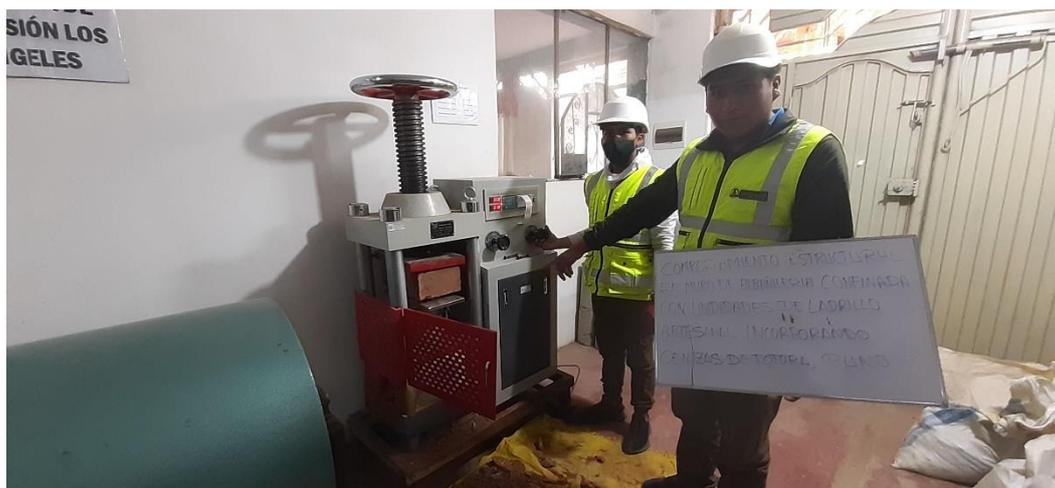
**Descripción:** Vista donde se aprecia el ensayo de la resistencia a la flexión de prisma de ladrillos artesanales incorporando cenizas de totora en diferentes porcentajes (5%, 10% y 15%).
