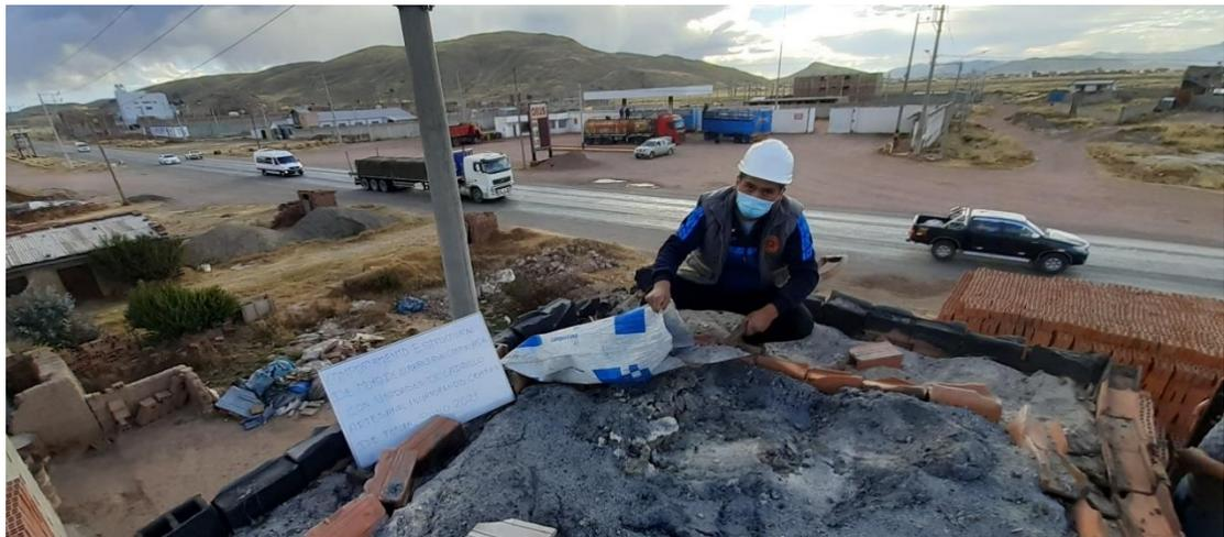
**Descripción:** Vista donde se aprecia el retiro de calcinación de la ceniza de totora, luego ser molido y reducir el tamaño para obtener un material fino.
