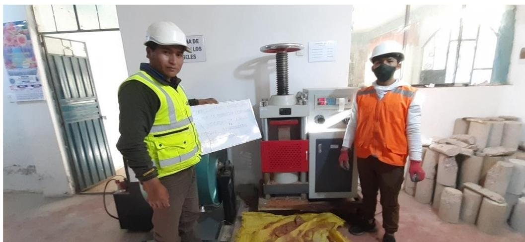
**Descripción:** Vista donde se aprecia el ensayo de la resistencia a la compresión de prisma de ladrillos artesanales incorporando cenizas de totora en diferentes porcentajes (5%, 10% y 15%).
