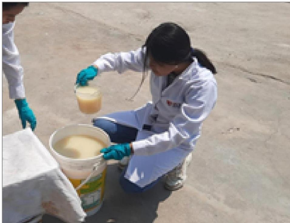
**Figura 6.** Filtrado del agua residual utilizando un tamiz.
