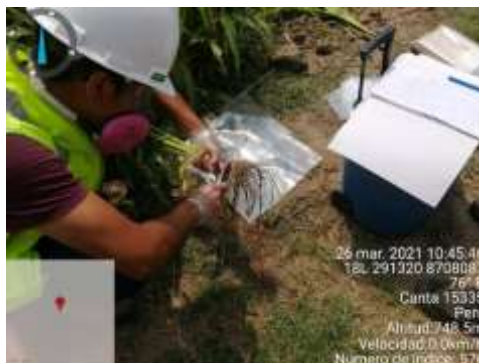
Fuente: Elaboración propia Figura N° 58: Recolección de las raíces para su respectivo traslado al laboratorio y realizar los análisis
