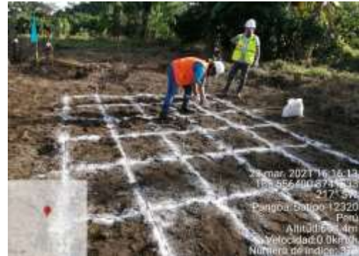
Fuente: Elaboración propia Figura N° 55: Aplicación del muestreo de rejilla simple.
