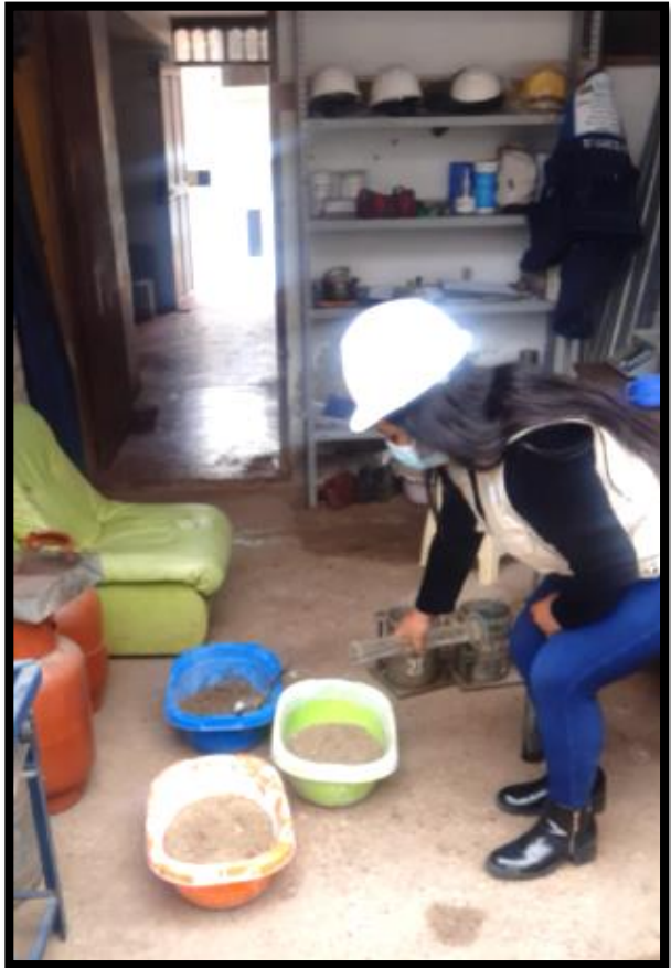
Adición de óptimo contenido de agua para su compactación.
