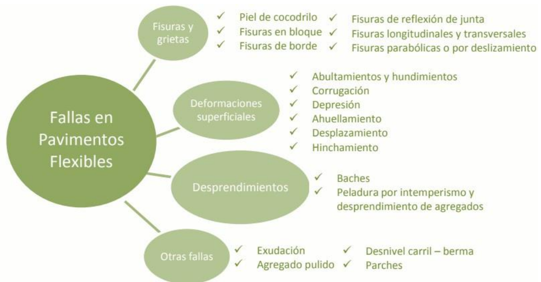
Figura 3. Resumen de fallas en Pavimentos flexibles
