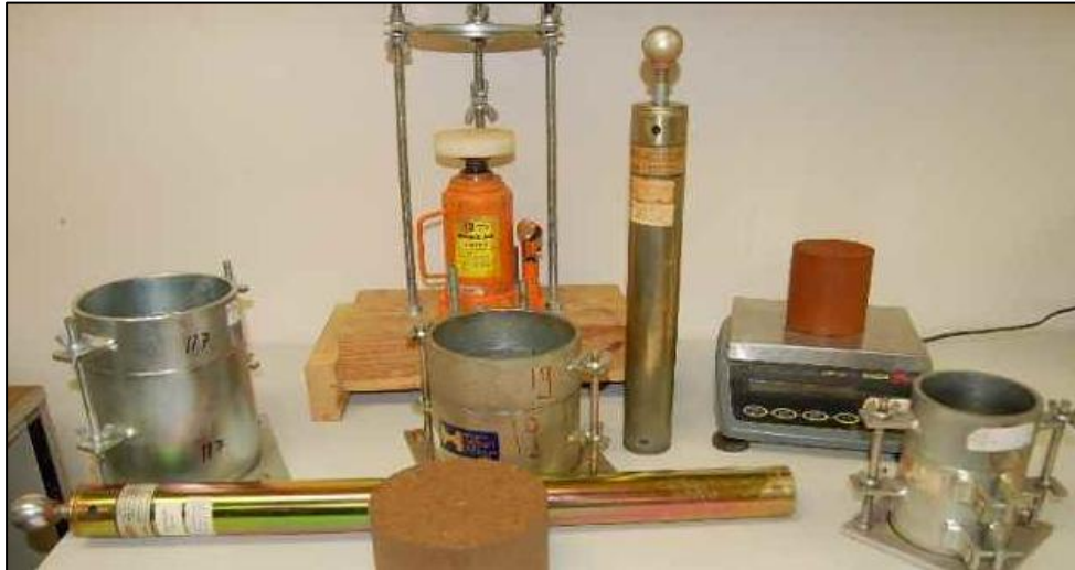
Figura 8. Materiales e instrumentos para el ensayo del CBR
