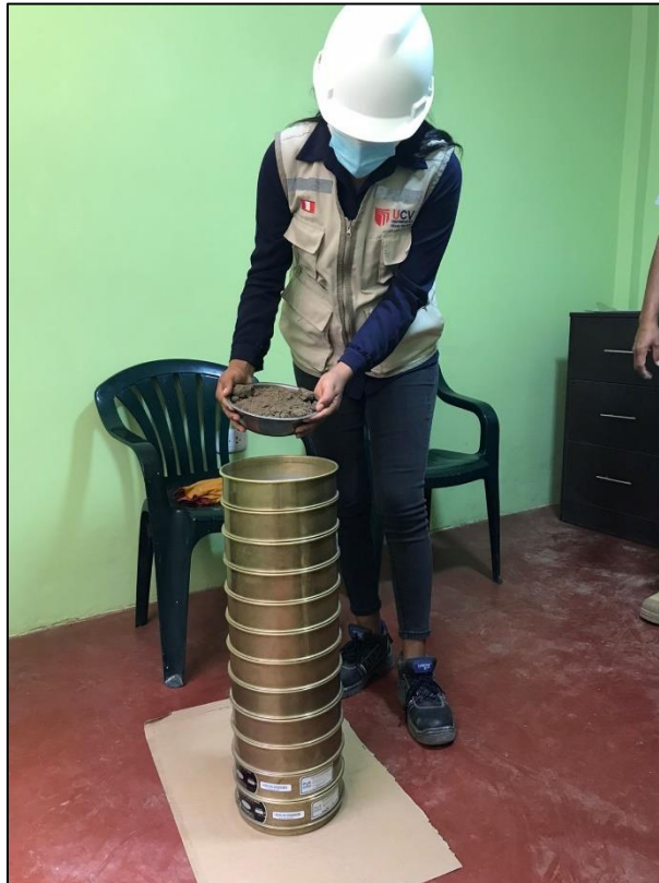
Fotografía 13. Estudio de Mecánica de Suelos - Granulometría
