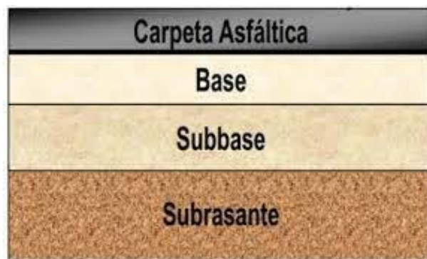
Figura 1. Perfil del Pavimento Flexible
