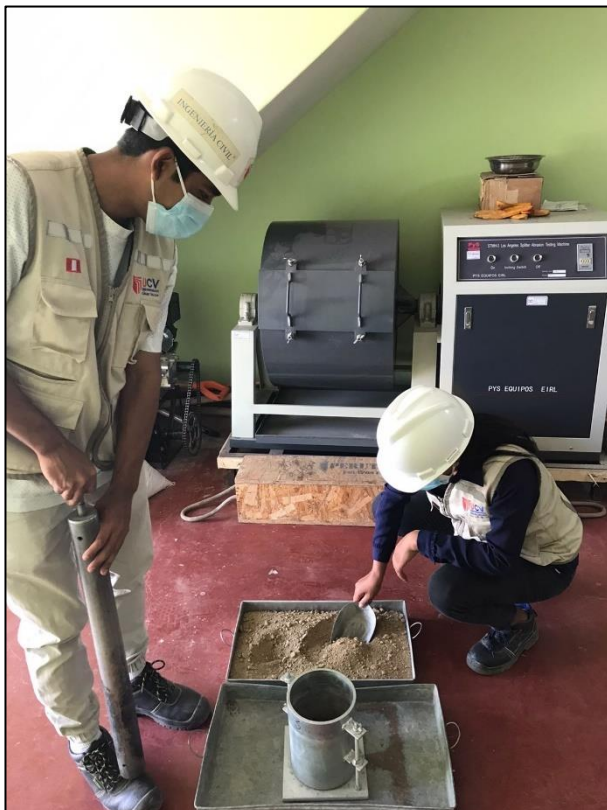
Fotografía 18. Estudio de Mecánica de Suelos – Proctor Modificado
