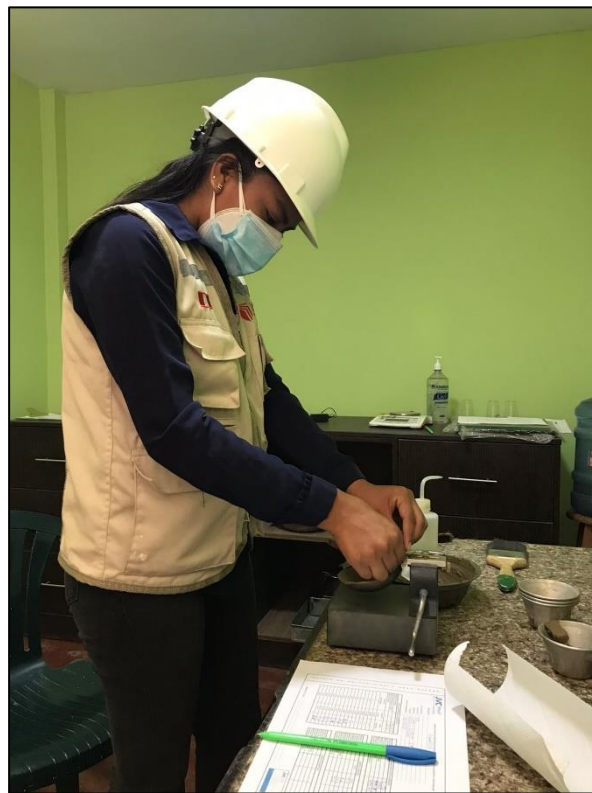
Fotografía 10. Estudio de Mecánica de Suelos – Límite Líquido
