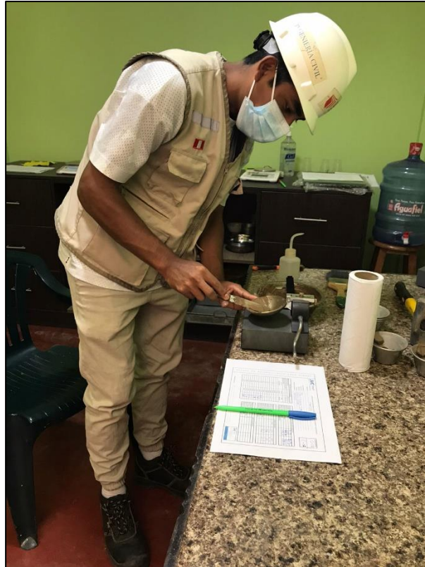
Fotografía 9. Estudio de Mecánica de Suelos – Límite Líquido
