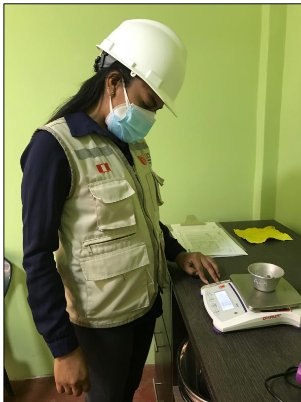
Fotografía 12. Estudio de Mecánica de Suelos – Límite Plástico
