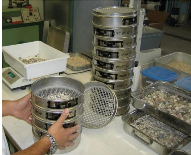
Figura 4. Granulometría por tamizado
