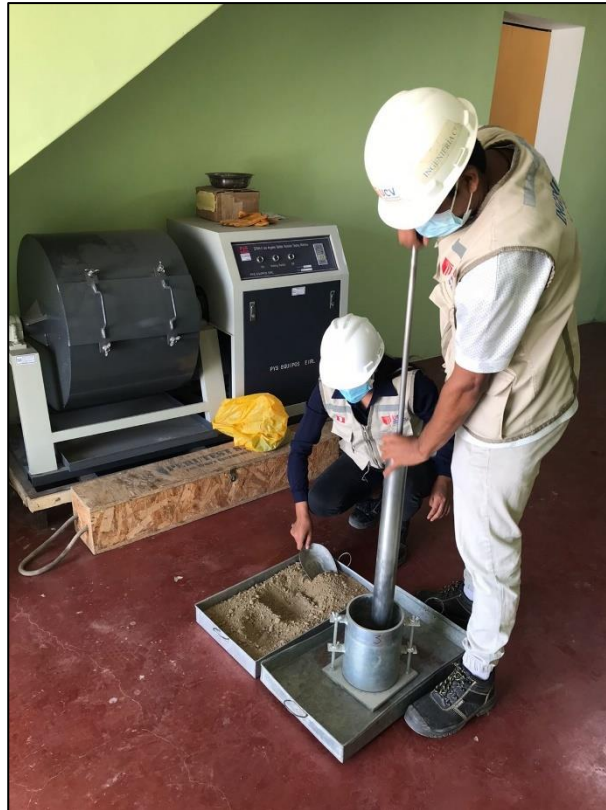
Fotografía 19. Estudio de Mecánica de Suelos – Proctor Modificado
