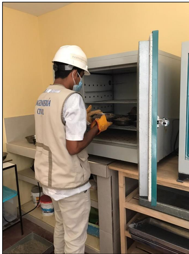
Fotografía 16. Estudio de Mecánica de Suelos – Porcentaje de Humedad
