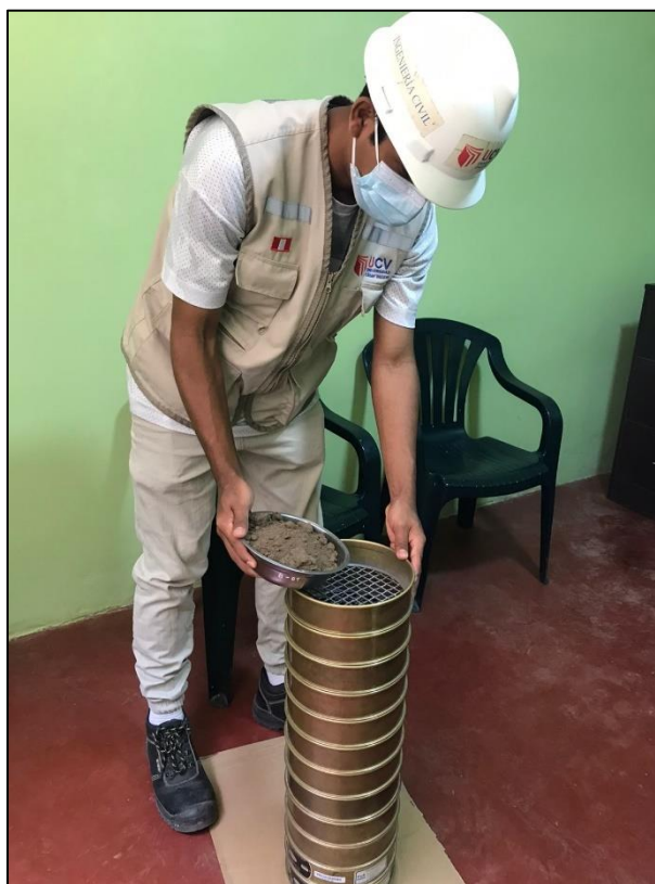
Fotografía 14. Estudio de Mecánica de Suelos - Granulometría
