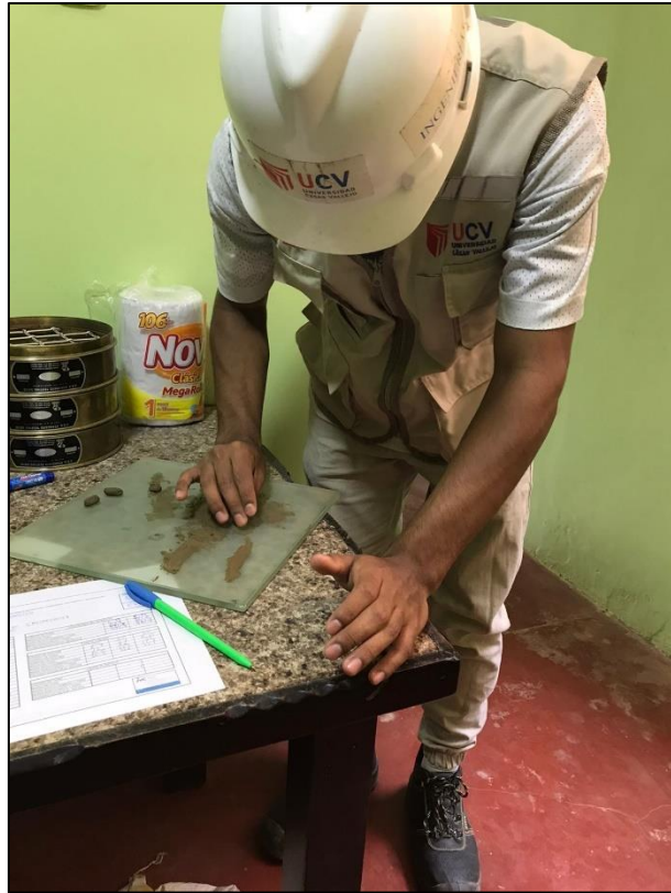
Fotografía 11. Estudio de Mecánica de Suelos – Límite Plástico
