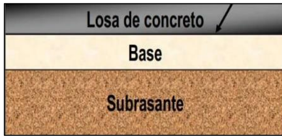
Figura 2. Perfil del Pavimento Rígido
