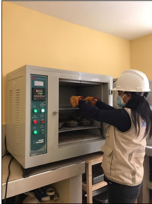
Fotografía 15. Estudio de Mecánica de Suelos – Porcentaje de Humedad
