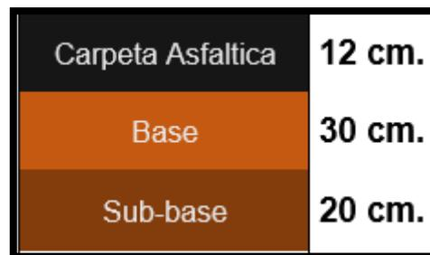
**Figura 25.** Espesores de capas del pavimento
