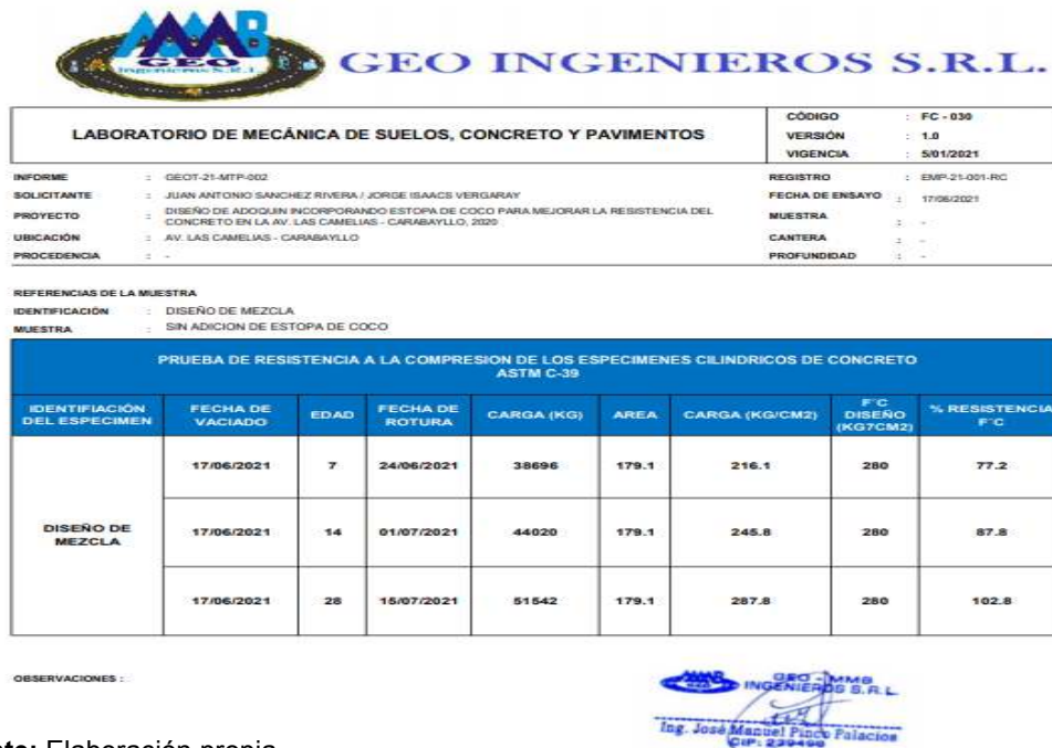
Figura 14: Resultados de prueba de compresión a especímenes cilíndricos de concreto sin estopa de coco
