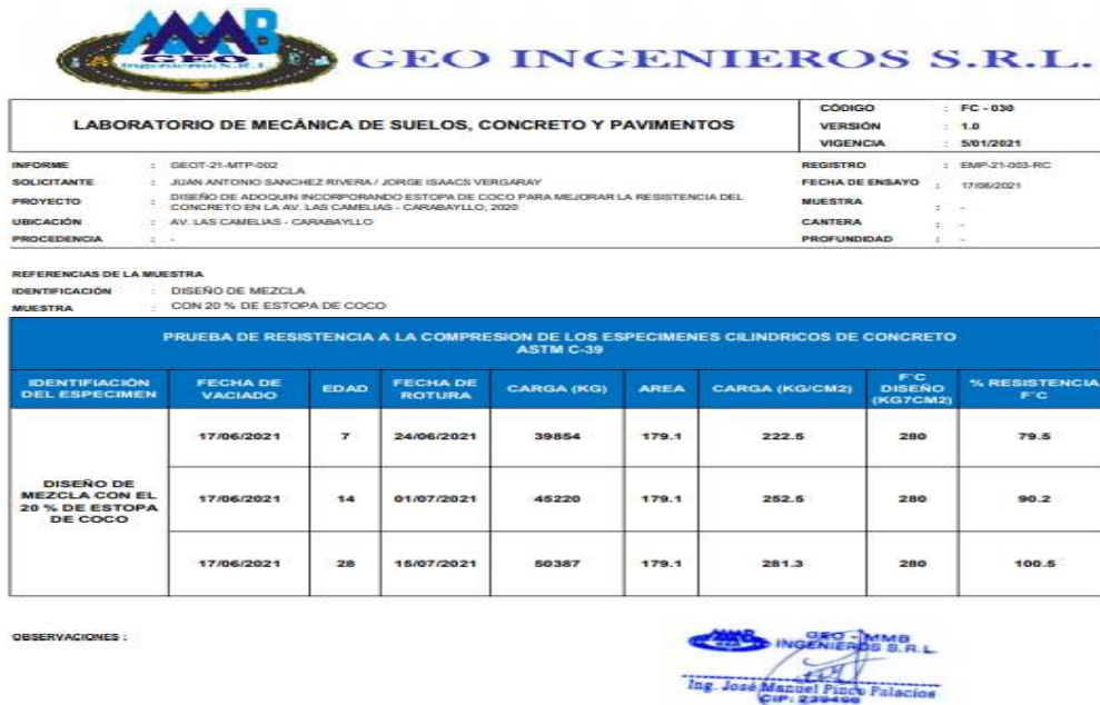
Figura 18: Resultados de prueba de compresión a especímenes cilíndricos de concreto con fibra de estopa de coco al 20%.
