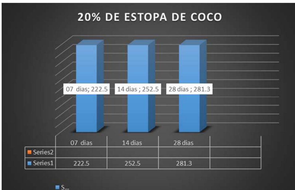
Figura 19: Resultados de prueba de compresión a especímenes cilíndricos de concreto con 20% de fibra de estopa de coco
