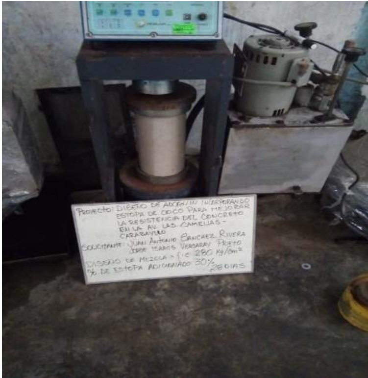
Figura 26: muestras cilíndricas con 30% de estopa de coco a 28 días.
