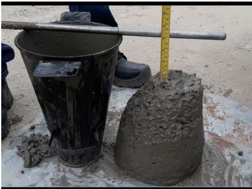
Figura 27: realización de cono de abrahams.
