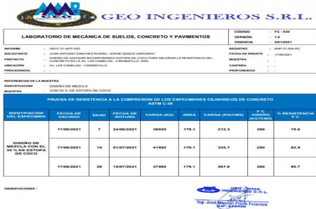
Figura 20: Resultados de prueba de compresión a especímenes cilíndricos de concreto con 30% de fibra de estopa de coco
