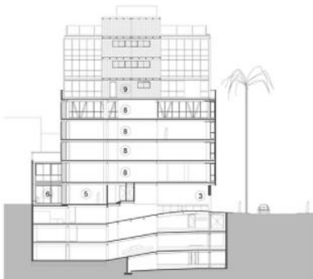
Figura 23: Corte transversal – Centro Empresarial Torre Centenario
