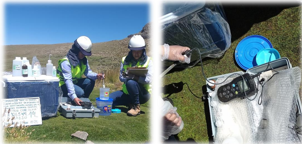
Figura 19. Obtención de parámetros en campo con un multímetro
