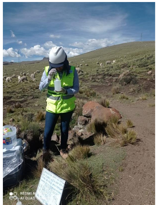
Foto 04: Utilización de preservantes
