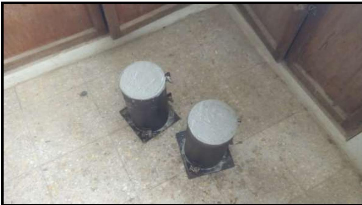
Figura 17. Liberación del concreto de las probetas.
