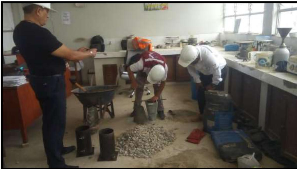
Figura 14. Ensayo del cono de Abrams.
