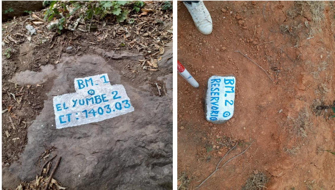
. Imagen 5 y6. Monumentación de BM's en la captación y el reservorio.
