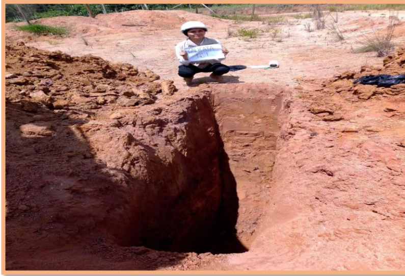
Foto N°1: Excavación calicata N°1
