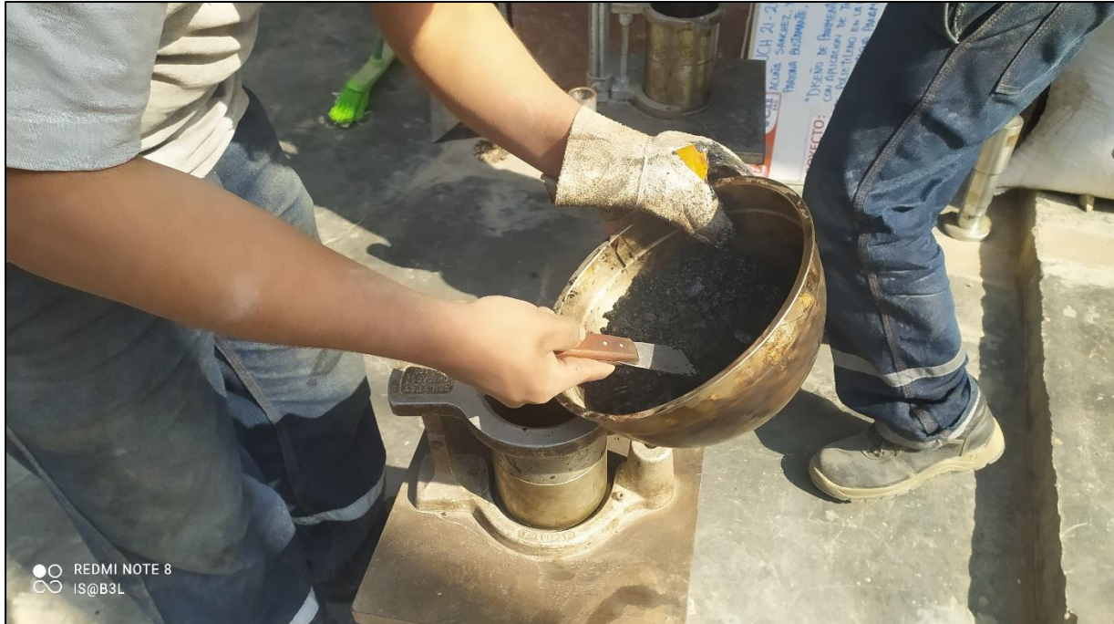
Llenado del molde con la mezcla asfáltica convencional
