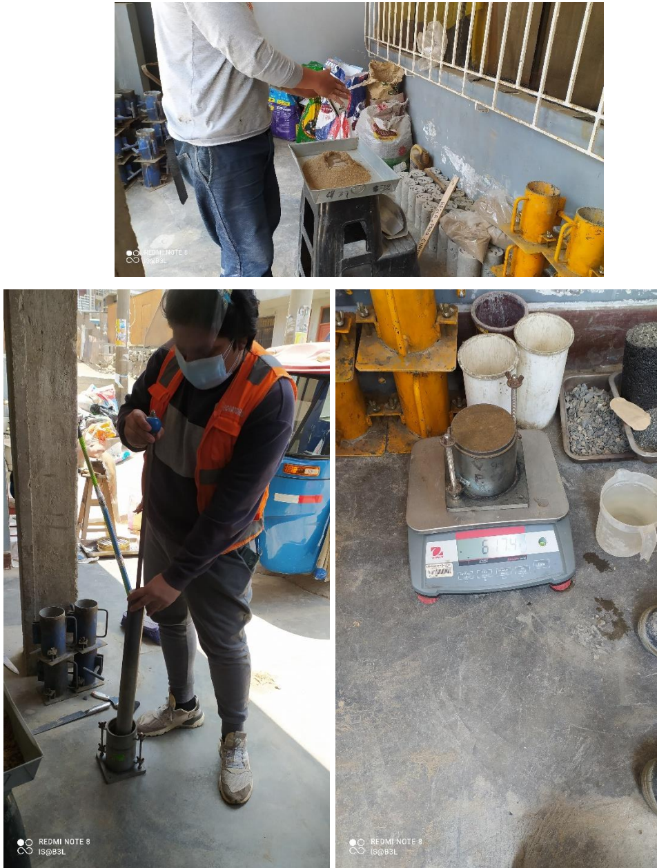
Figura 19. Elaboración del Proctor Modificado del C01
