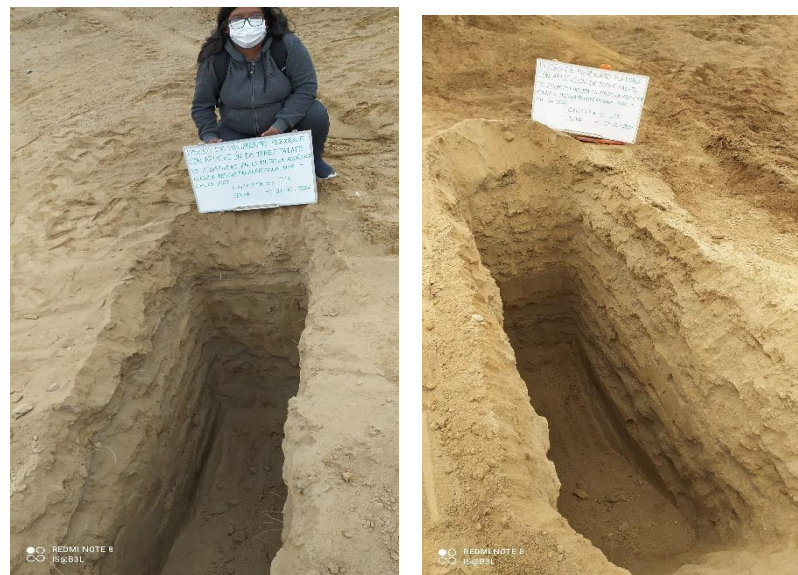
Figura 14. Elaboración de la tercera calicata
