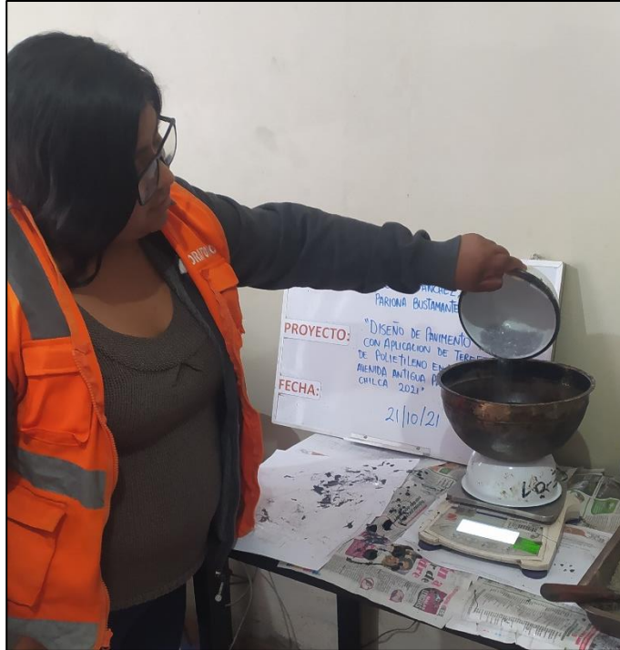
Se hecha el Tereftalato de Polietileno a la mezcla asfáltica
