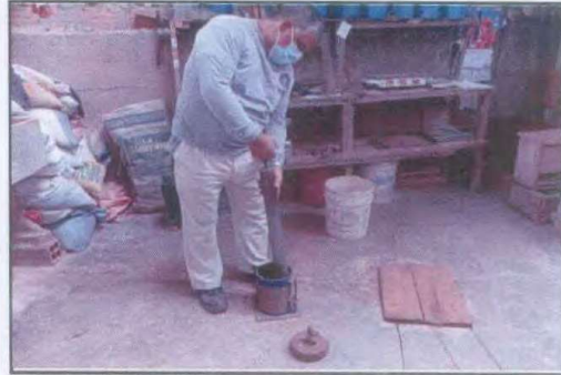
FOTO Nº 02: SE OBSERVA AL PESONAL TECNICO COMPACTANDO LA MUESTRA PARA EL ENSAYO DE CBR
