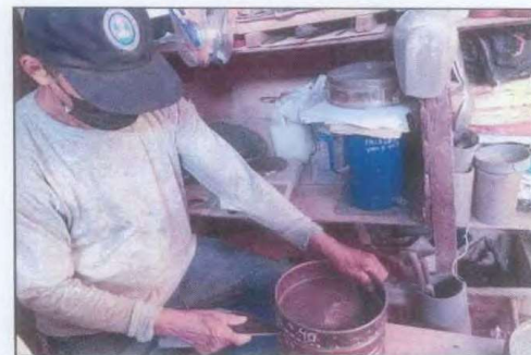
FOTO Nº 04: SE OBSERVA AL PERSONAL TECNICO TAMIZANDO LA MUESTRA
