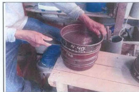
FOTO Nº 05: SE OBSERVA AL PERSONAL TECNICO CONTINUANDO CON EL TAMIZADO DE LA MUESTRA
