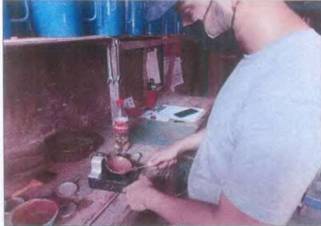
FOTO Nº 01: SE OBSERVA AL PERSONAL TECNICO INICIANDO CON EL ENSAYO DE LIMITE
