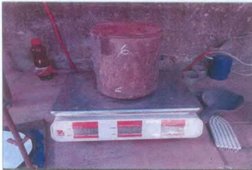
FOTO Nº 03: SE OBSERVA AL PERSONAL TECNICO PESANDO EL MOLDE PARA EL ENSAYO DE CBR
