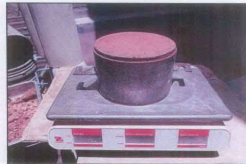
FOTO Nº 06: SE OBSERVA AL PERSONAL TECNICO PESANDO LA MUESTRA DEL ENSAYO DE PROCTOR MODIFICADO
