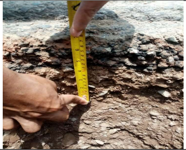
imagen 2: BASE 0.20M Y SUBBASE 0.70m
