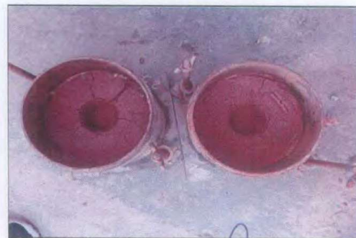
FOTO Nº 06: SE OBSERVA LAS MUESTRAS DESPUES DEL ENSAYO DE CBR
