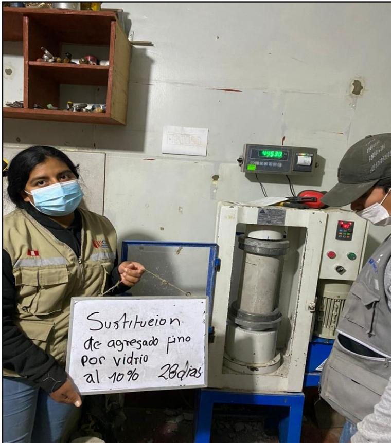
Ruptura de probeta
