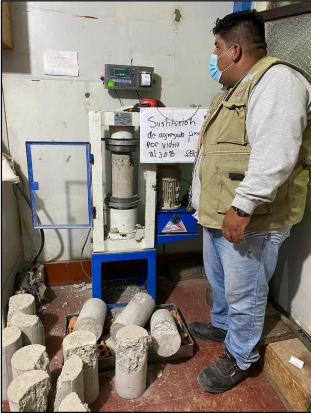
Ruptura de probeta
