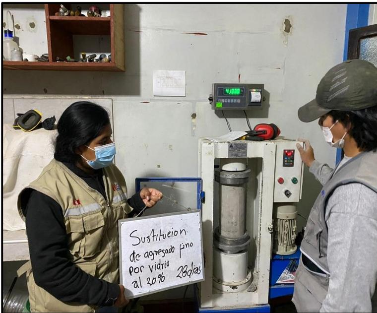
Ruptura de probeta
