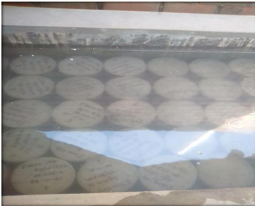
*Probetas de concreto de 3kg y 4kg de fibra en la poza de curado*
