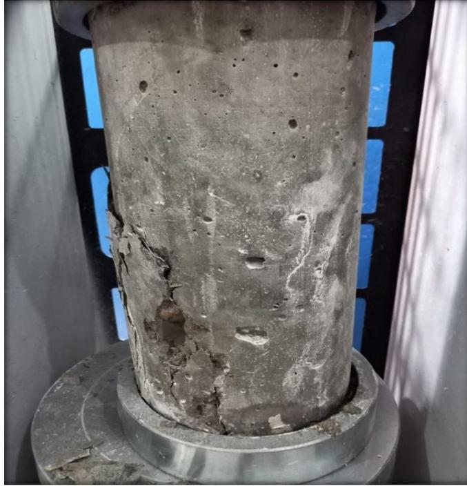
**Ruptura de Concreto con adición de 4kg de fibra de acero a los 23 días**
