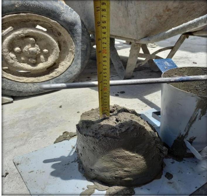
*Prueba de slump de la mezcla de concreto con adición de 1kg de fibra de acero*
