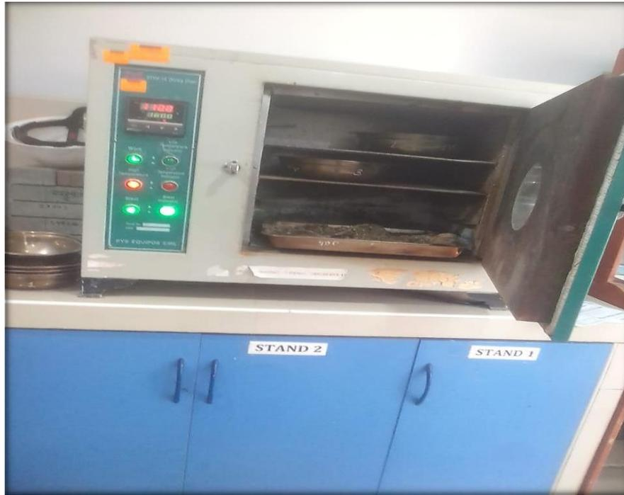
*Materiales Puestos al Horno para el secado*
