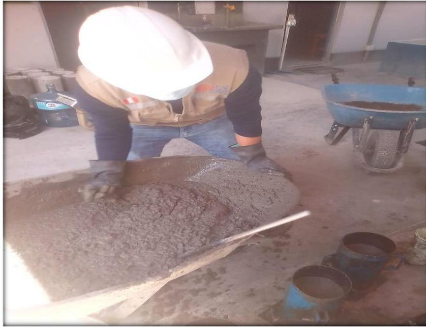
*Mezcla para testigos del Concreto Patrón*
