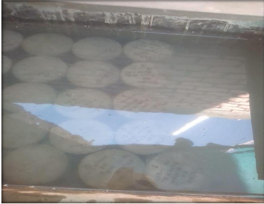
*Probetas de concreto patrón en la poza de curado*
