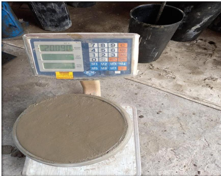
*Peso Unitario de la mezcla de concreto con adición de fibra de acero con 2kg*
