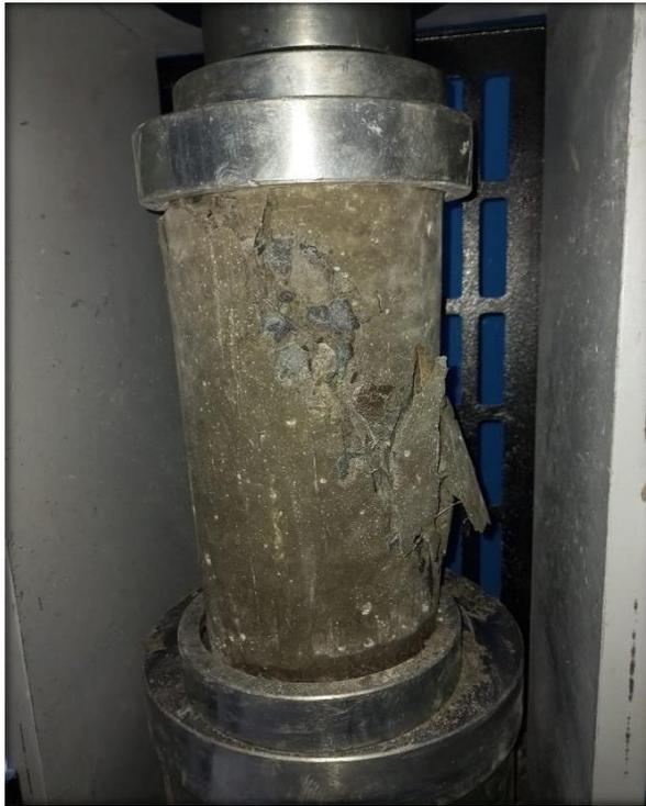
**Ruptura de Concreto con adición de 2kg de fibra de acero a los 23 días**
