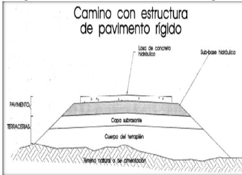
Estructura de un Pavimento Rígido.
