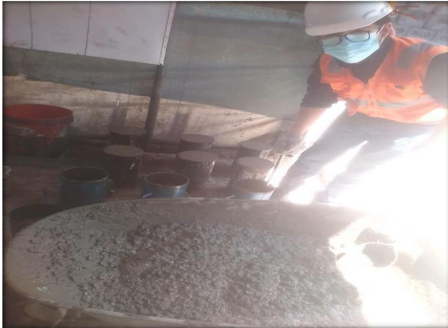
*Llenado de la mezcla de concreto con adición de 1kg de fibra de acero a las probetas*
