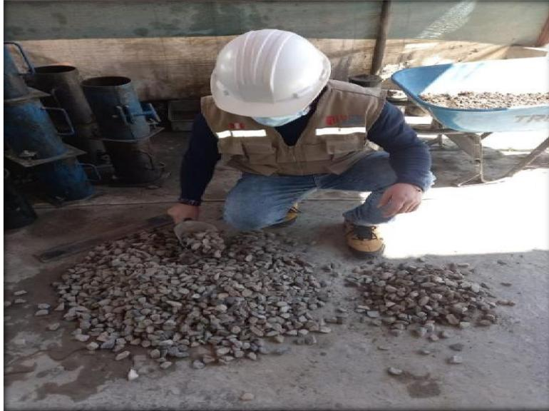
*Preparado del agregado grueso para el cuarteo del material*
