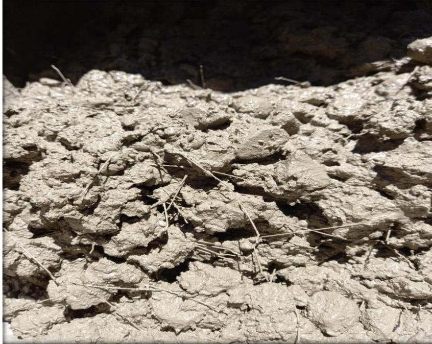
*Mezcla de concreto con adición de fibra de acero con 2kg*
