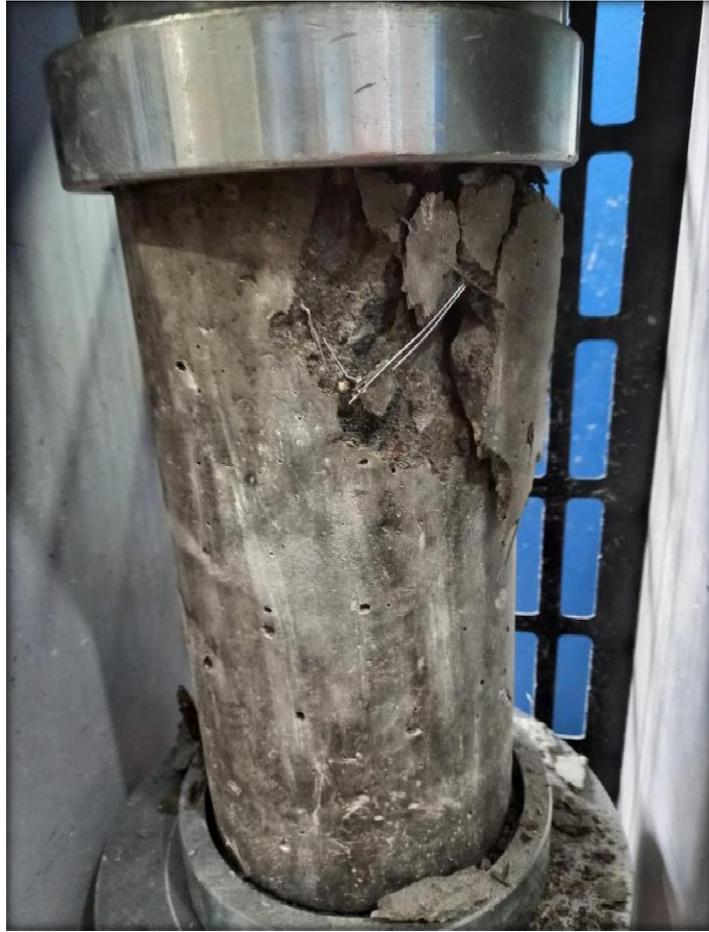
**Ruptura de Concreto con adición de 3kg de fibra de acero a los 23 días**
