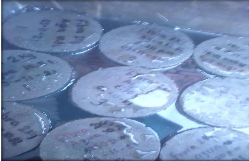
*Probetas de concreto de 2kg de fibra en la poza de curado*
