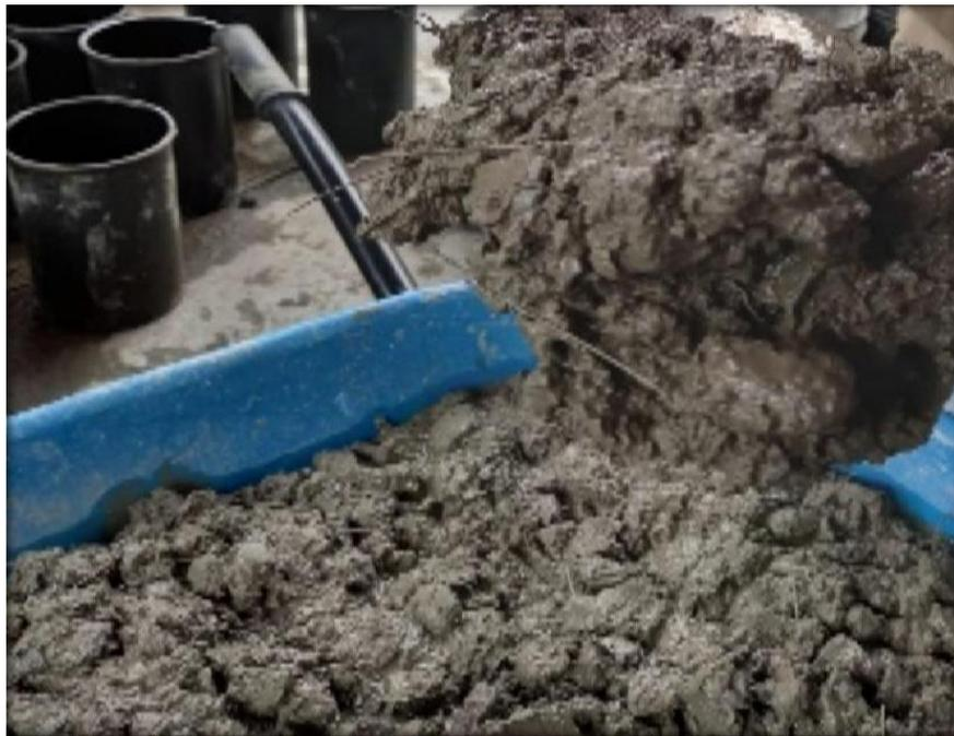
*Mezcla de concreto con adición de fibra de 4kg*
