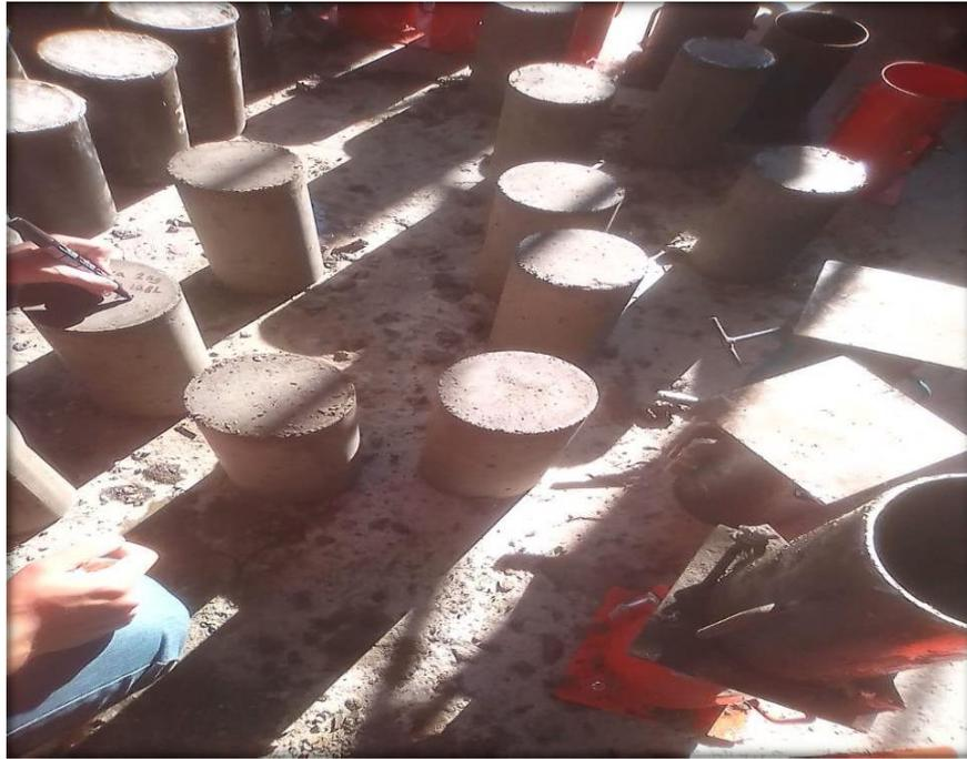
*Desmoldado de las probetas*
