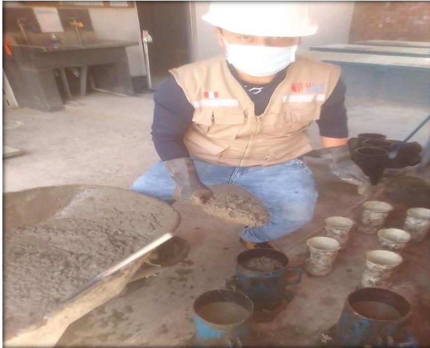
*Llenado de la mezcla a las probetas con fibra de acero de 3kg*
