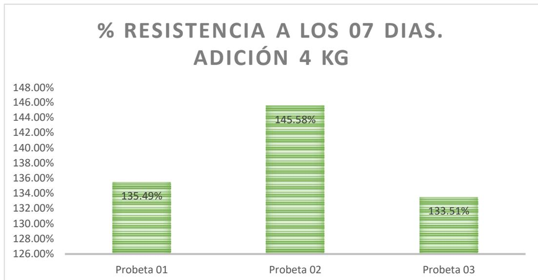
**Figura No 06: Porcentaje de Resistencia obtenida a los 07 días del Concreto con Adición de 4kg**
