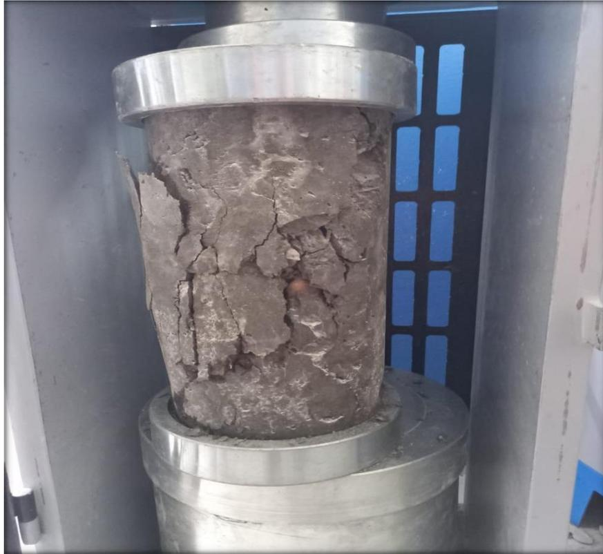
**Ruptura de Concreto con Adición de Fibra de Acero a los 23 días**
