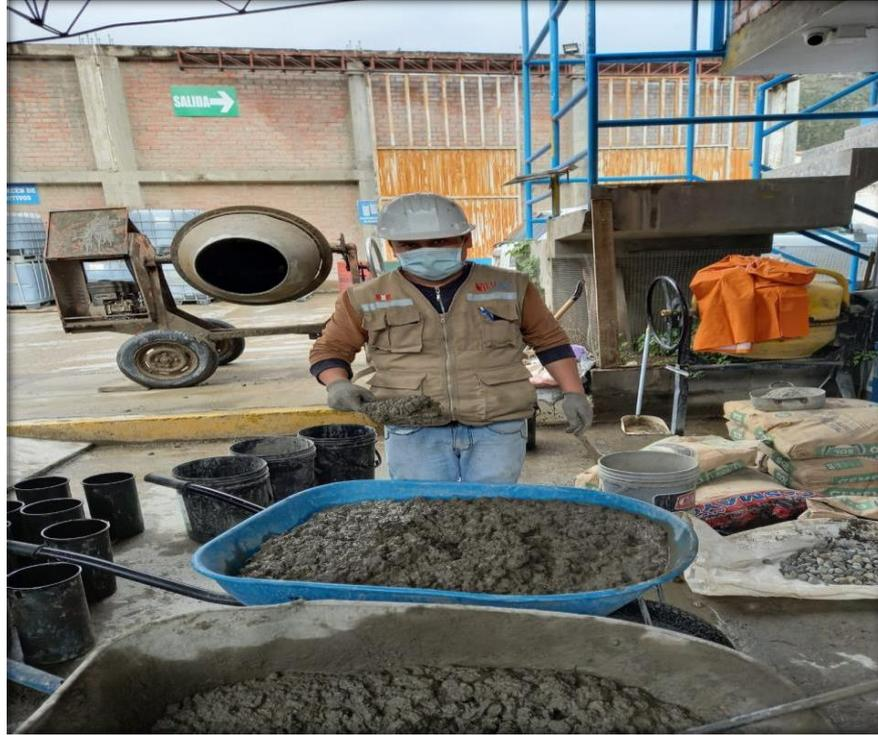
*Muestra del concreto con adición de fibra de 1kg*
