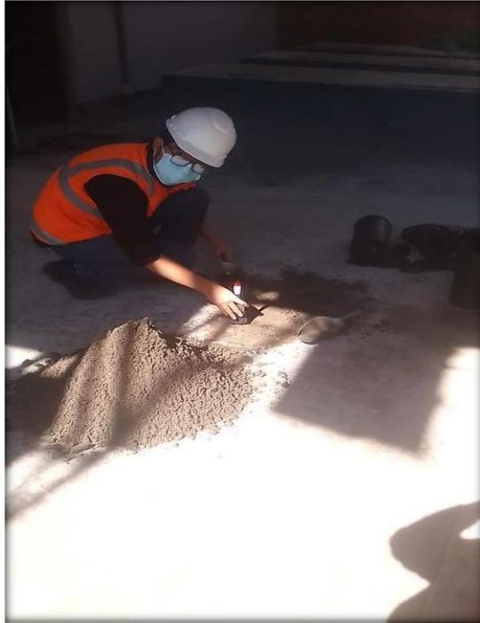
*Juntado de material fino para previo peso, para los formatos de laboratorio*
