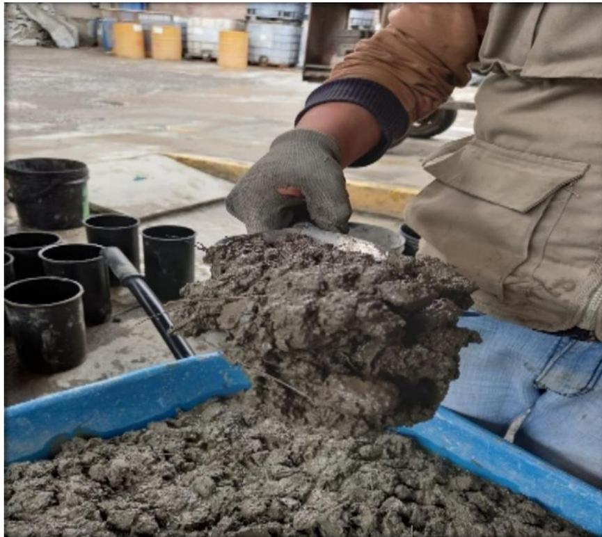
*Muestra de la Adición de fibra de 3kg a la mezcla del concreto*
