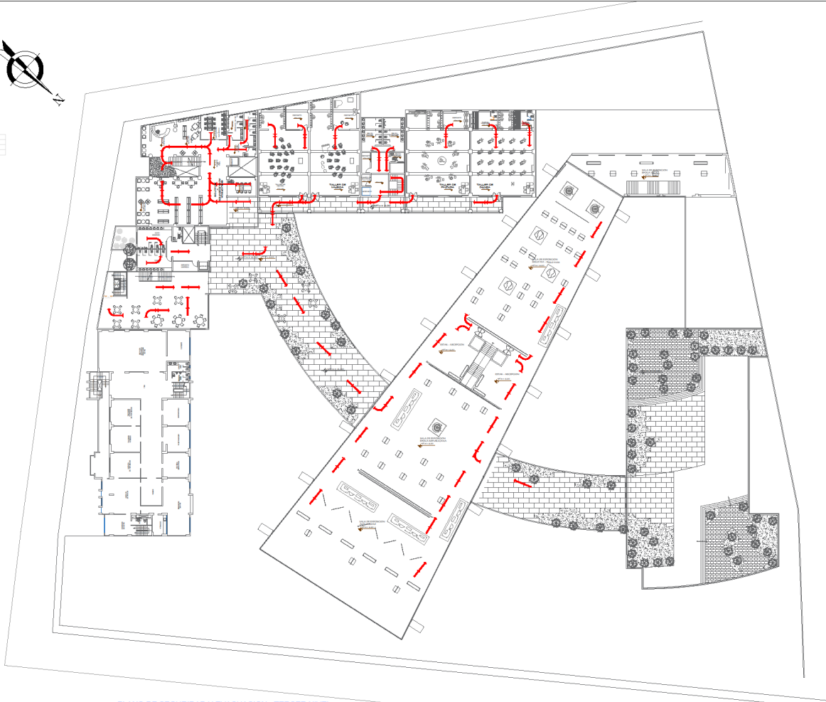
PLANO DE SEGURIDAD Y EVACUACION - TERCER NIVEL
