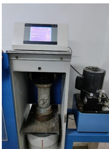
Figura 35: Ensayo de Rotura de Probetas – Diseño Patrón.
