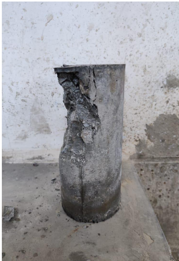
Figura 37: Falla Estructural a la Probeta de Ensayo.
