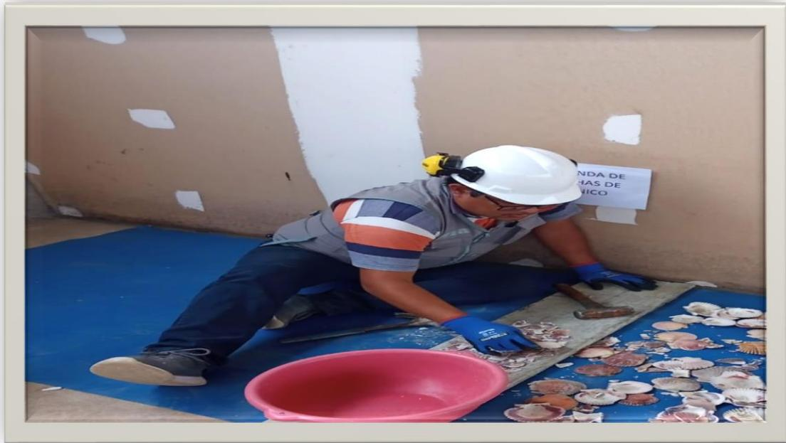
**Figura 20 y 21:** se observa el proceso de molienda de las muestras recolectadas de la Concha de Abanico
