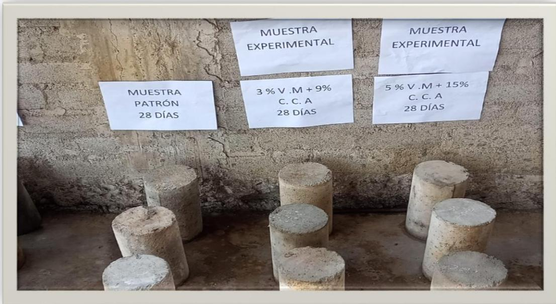
**Figura 35:** Se observa las muestras separadas por grupos experimentales a los 28 días para el ensayo de rotura de probetas
