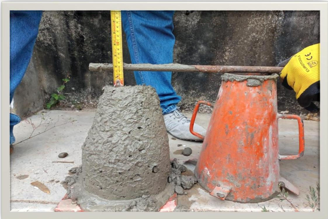
**Figura 29:** Se realizo la prueba de slump (cono de abrams)
