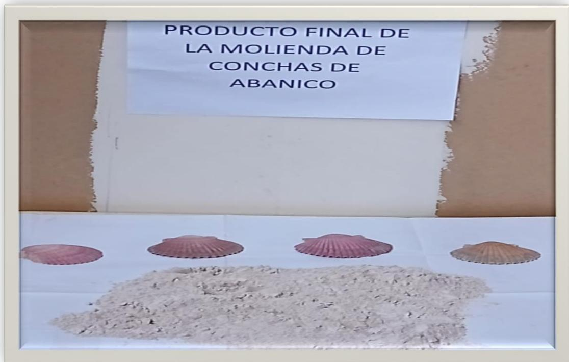
**Figura 22:** se observa el producto final del proceso de molienda de las muestras recolectadas de la Concha de Abanico
