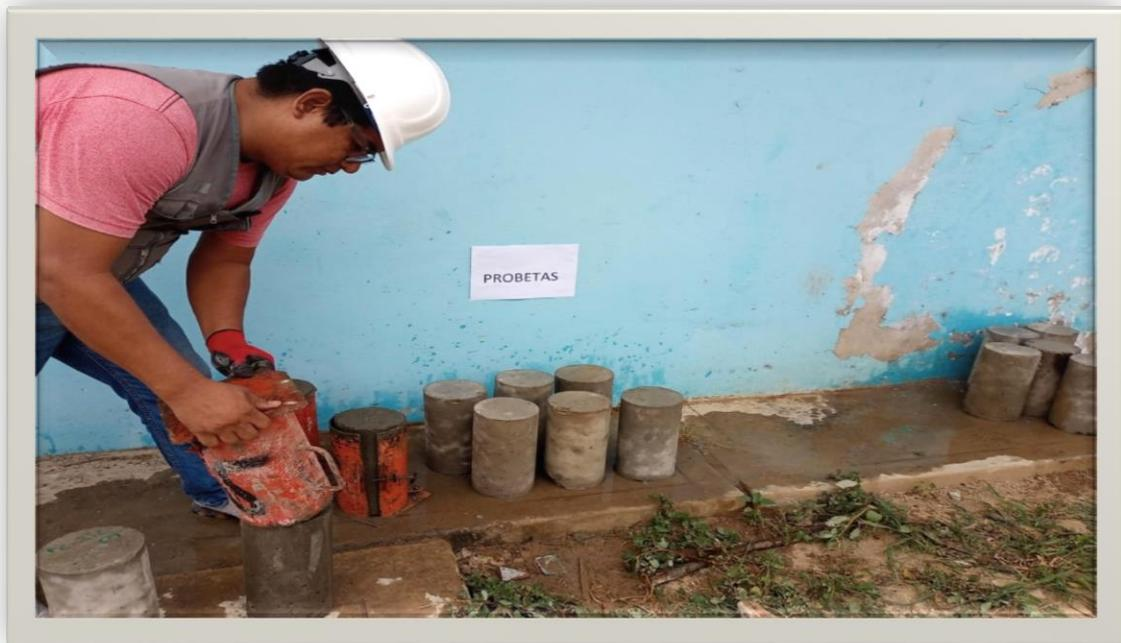
**Figura 31:** Se procedio al desencofrado de probetas del patron y las muestras experimentales
