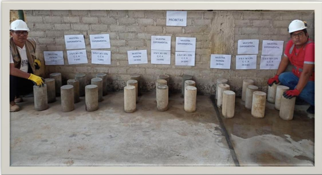
**Figura 32:** se realizó el desencofrado total de probetas tanto del patron y las muestras experimentales
