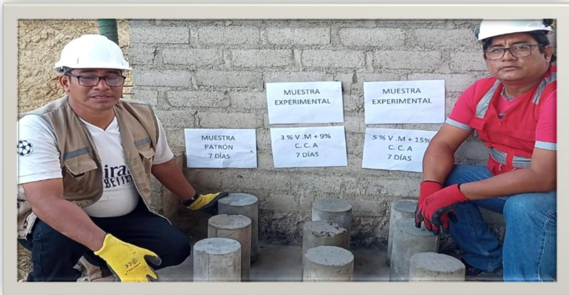
**Figura 33:** Se observa las muestras separadas por grupos experimentales a los 7 días para el ensayo de rotura de probetas
