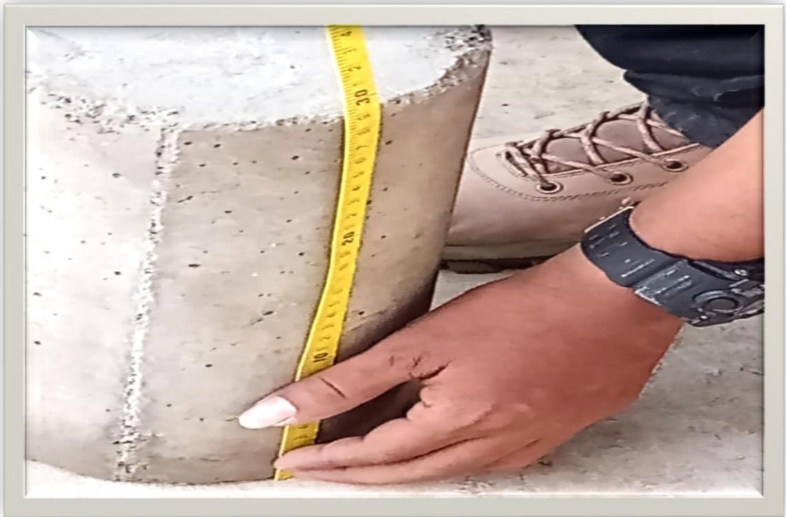
**Figura 37,38 y 39:** se observa las muestras siendo medidas por grupos experimentales a los 7 ,14, 28 días antes del ensayo de rotura de probetas
