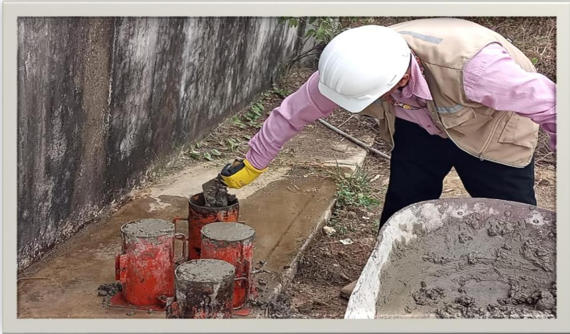
**Figura 30:** Se realizó el llenado de probetas del patron y las muestras experimentales
