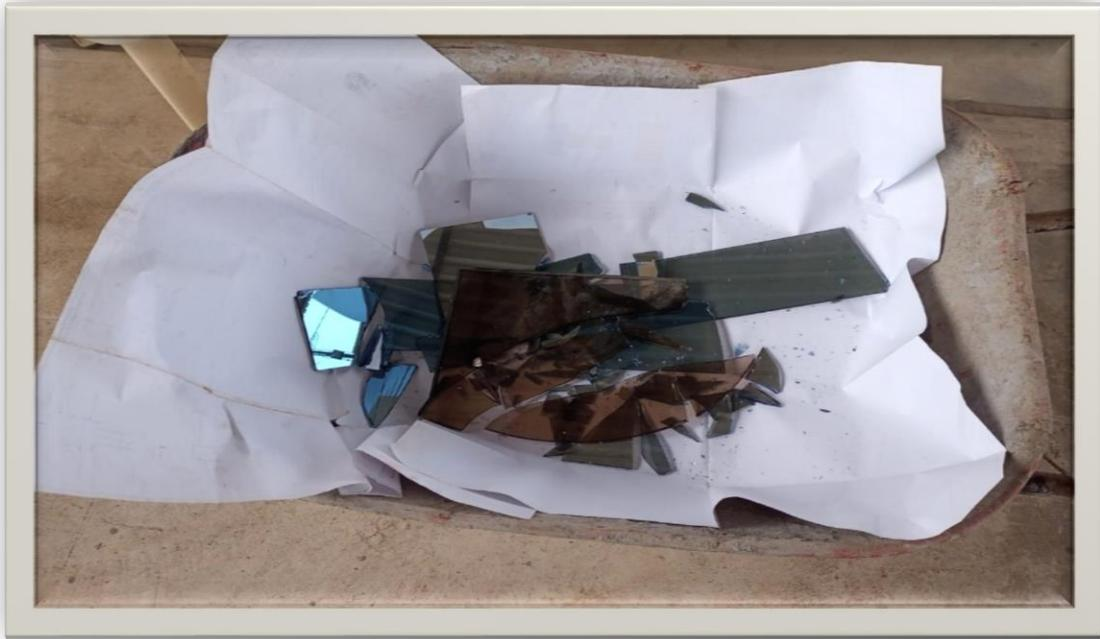
**Figura 25:** Se observa el vidrio reciclado limpio y listo para el proceso de molienda
