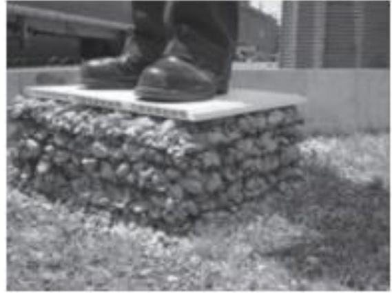
Figura 15. Confinamiento Lateral generado por la geomalla en un material granular. Fuente: Manual de Diseño con Geosintéticos, 2014.
