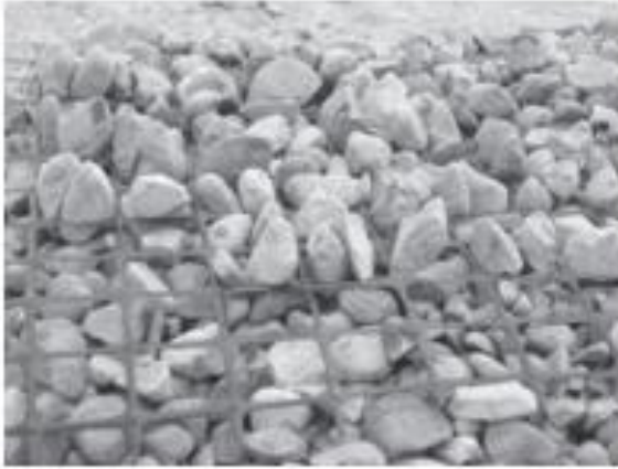
Figura 15. Confinamiento Lateral generado por la geomalla en un material granular. Fuente: Manual de Diseño con Geosintéticos, 2014.
