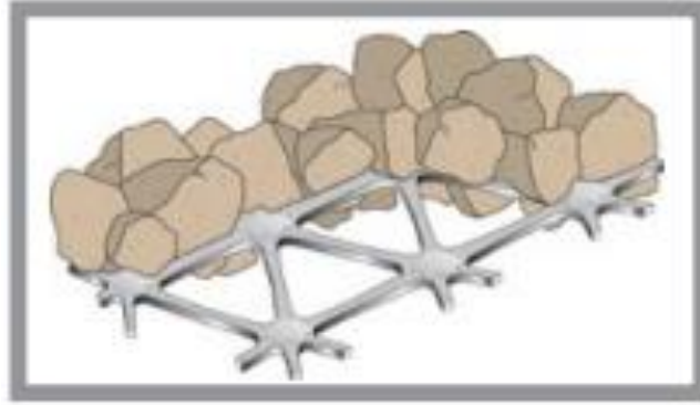
Figura 18. Estructura de las geomallas triaxiales. Fuente: Geomalla Tensar Triax.
