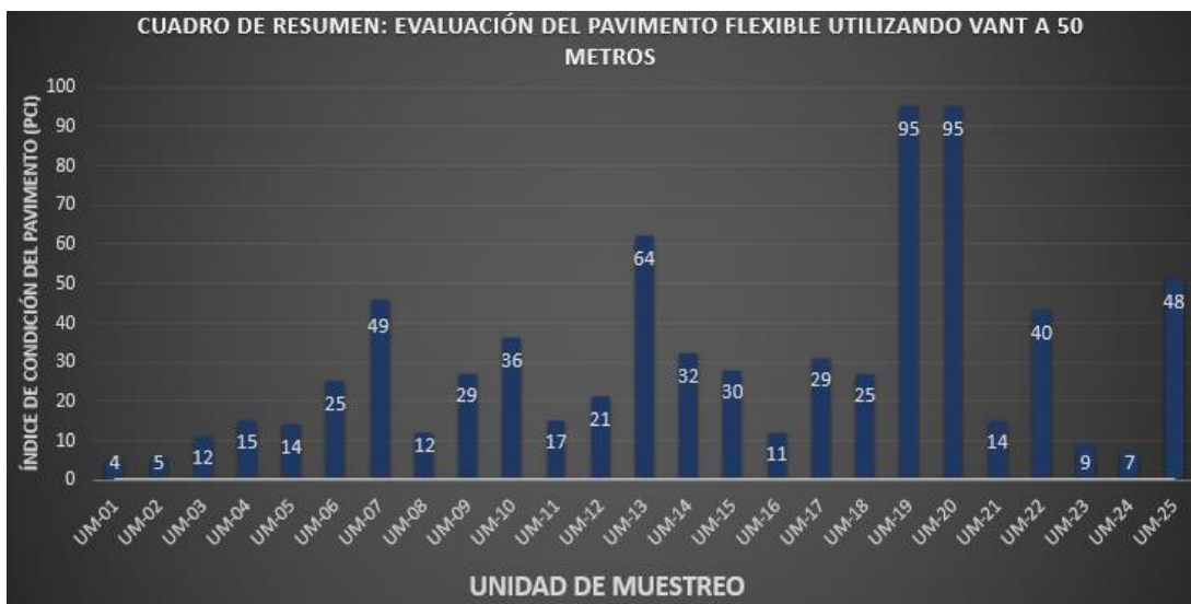
Figura 19: Resumen de evaluación del pavimento flexible utilizando VANT a 50 m
