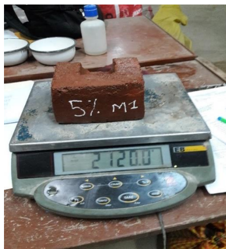
Figura 17. Peso saturado de la muestra luego de ser sumergido en agua durante 24 hrs.
