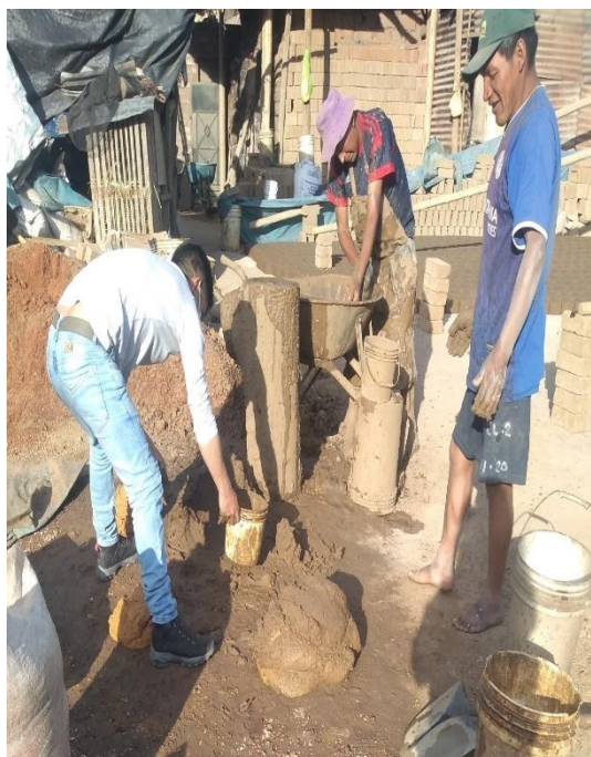
Fotografía 5. Mezcla uniforme entre la masa de la ladrillera y la masa Tepetate
