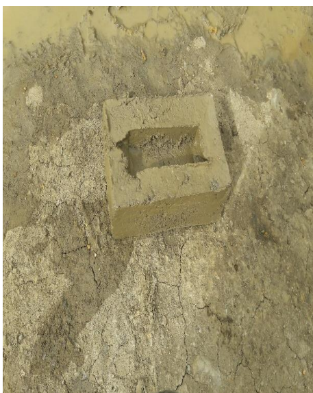
Figura 8. Ladrillo recién moldeado
