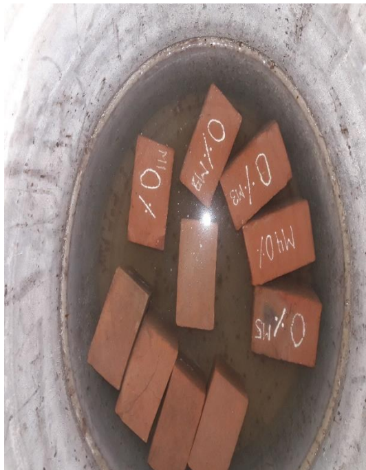
Fotografía 15. muestras sumergidas en agua por 24 horas
