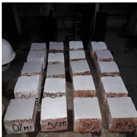
Figura 10. Medias unidades para el ensayo de Resistencia a compresión
