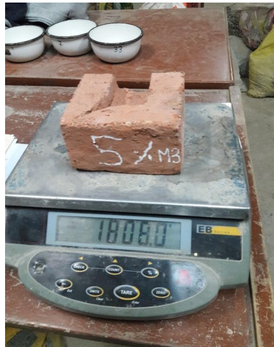
Fotografía 16. Ensayo de absorción de las medias unidades
