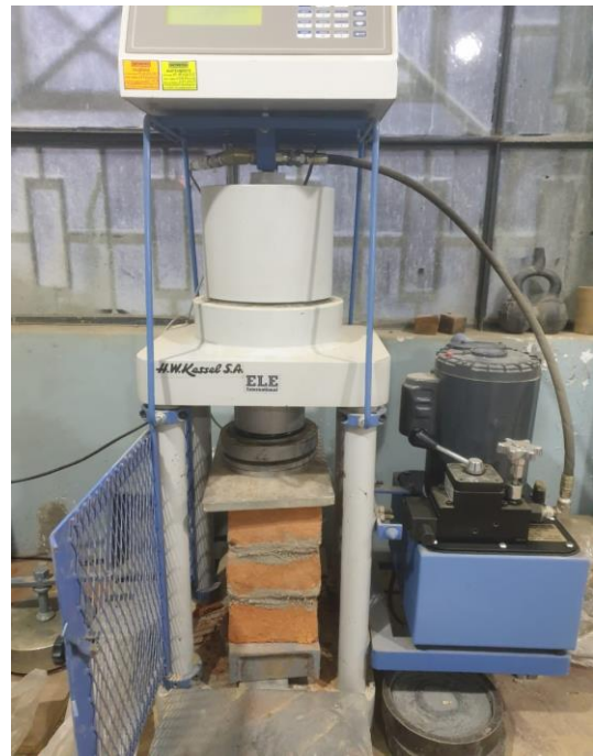
Fotografía 14. ensayo de resistencia a compresión axial de pilas
