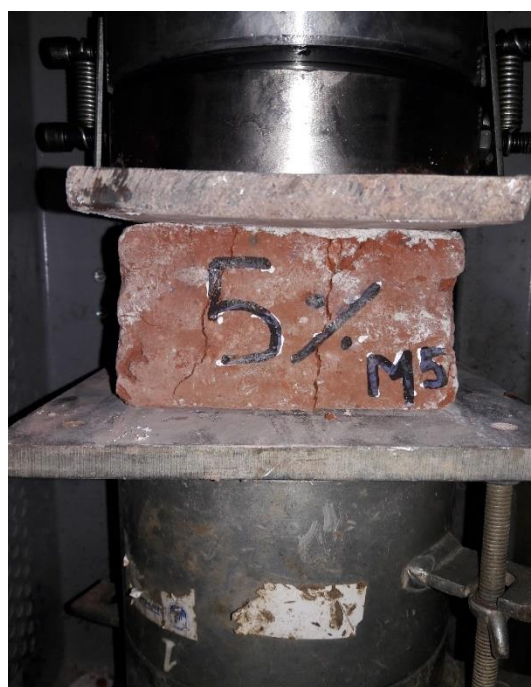
Fotografía 12. Ensayo de resistencia a compresión
