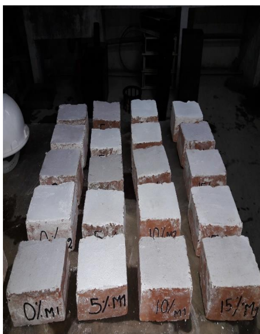
Fotografía 11. Medias unidades para el ensayo de resistencia a compresión
