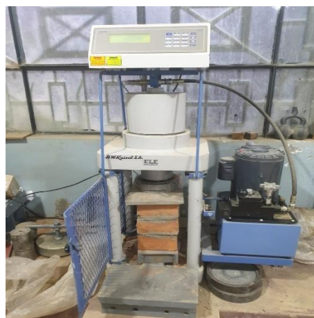
Figura 14. Roturas de las pilas de ladrillos
