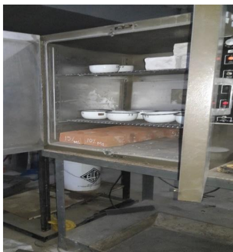
Figura 16. Medias unidades de albañilería secando en el horno durante 24 hrs.
