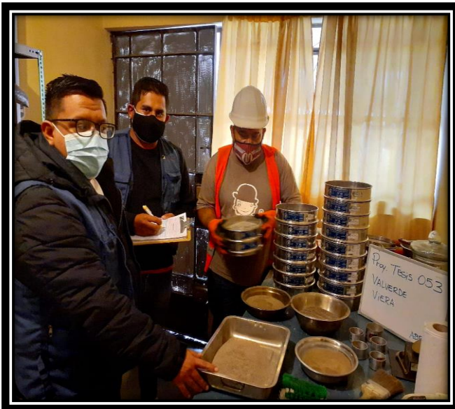
Figura 8: Granulometría de los materiales.
