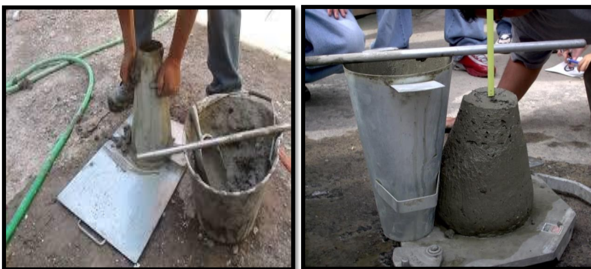
Figura 9: Ensayo de asentamiento del concreto
