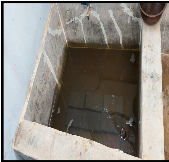
Figura 10: Testigos sumergidos por 24 horas.
