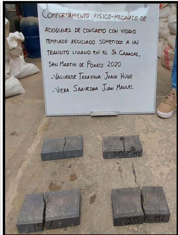
Fotografía 2: Rotura de testigos
