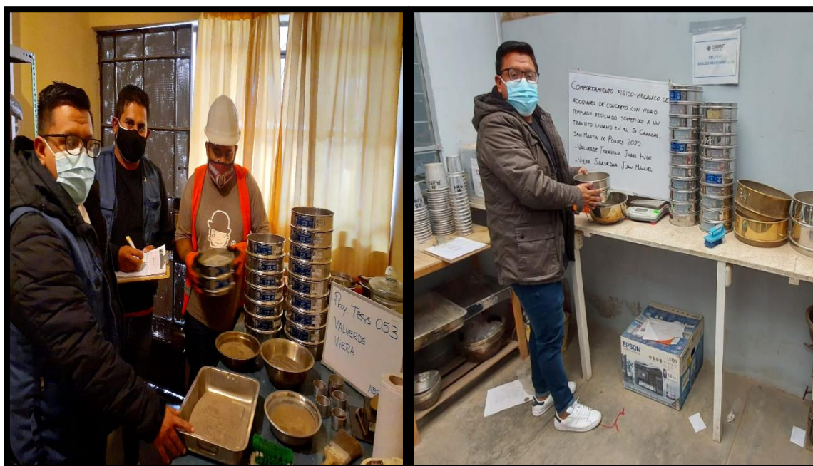
Figura 6: Ensayo de granulometría de agregado grueso y agregado fino
