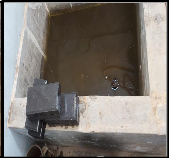
Figura 11: Testigos después de 24 horas sumergidos para el ensayo de absorción.
