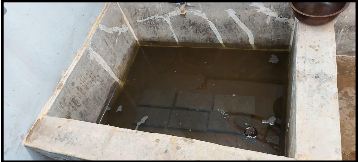
Fotografía 4: Testigos sumergidos 24 horas.
