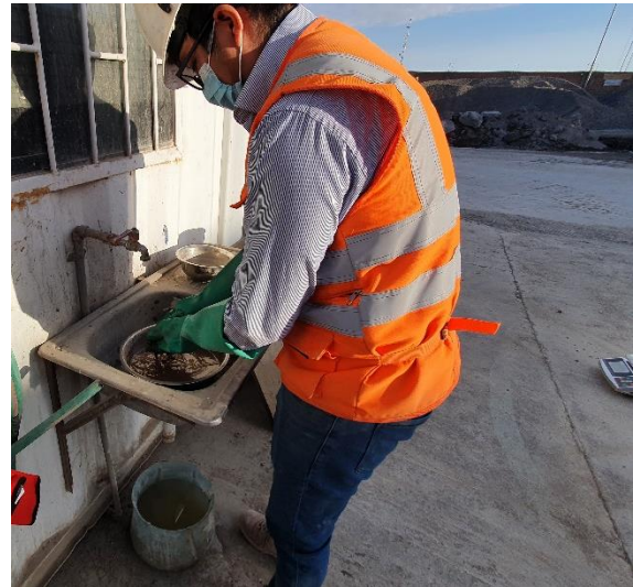
Lavado del agregado
