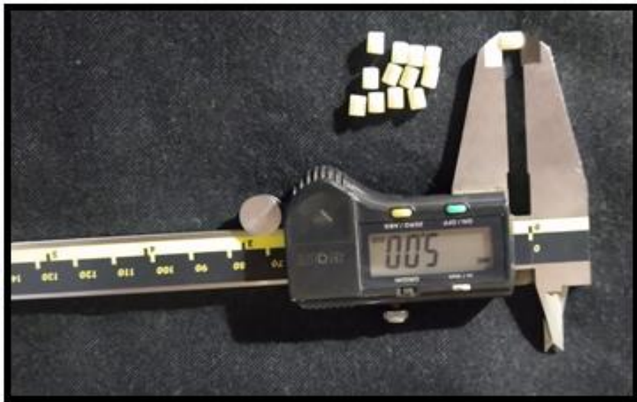
Figura 9: Medición del diámetro y la altura del espécimen con micrómetro digital
