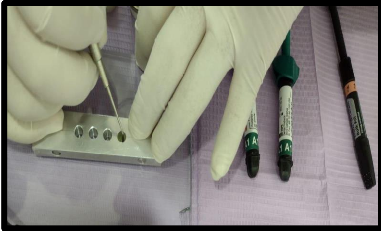
Figura 5: Inserción y compactación de la resina bulk dentro de la matriz metálica.
