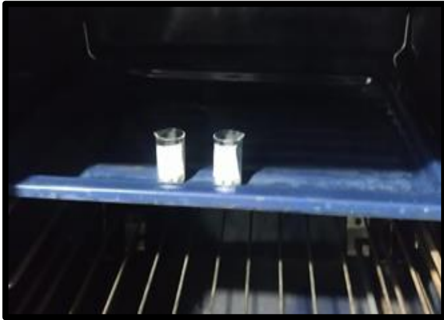
Figura 10: Se colocó los especímenes en vasos precipitados rotulados dentro de una estufa a 37°C por 24 horas
