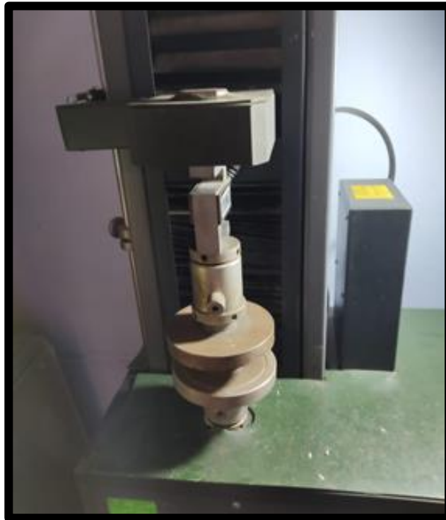
Figura 11: Máquina digital de ensayo universal CMT-5 L marca LG del laboratorio HIGH TECHNOLOGY LABORATORY CERTIFICATE S.A.C.
