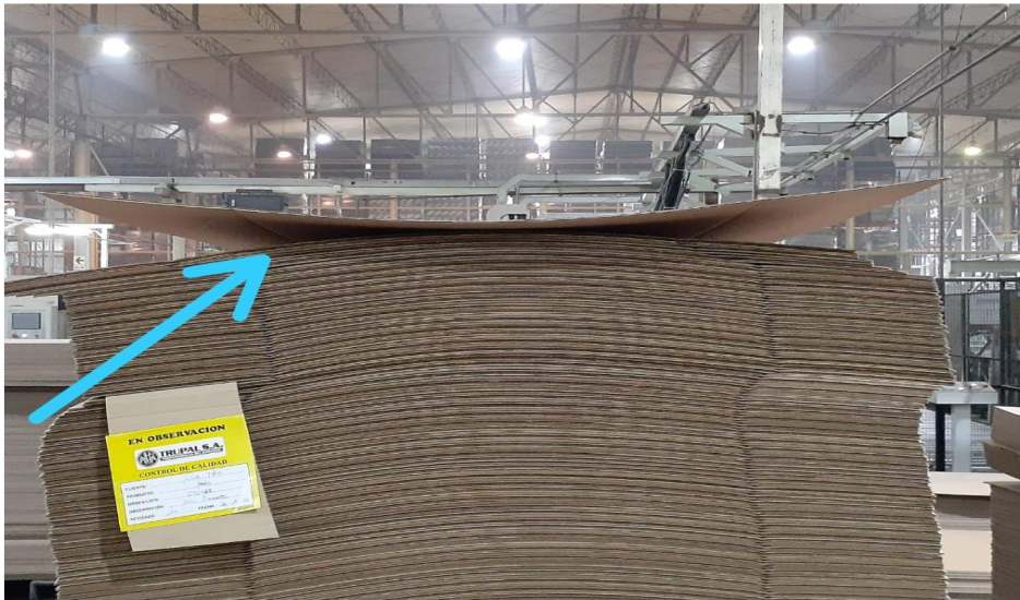
Figura 8. Producto No Conforme (por alabeo)
