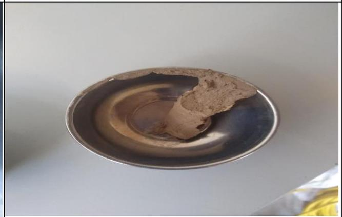
Se obtiene en totalidad 3 muestras del límite líquido, donde se llevó a un horno por 12 horas, para obtener los resultados.
