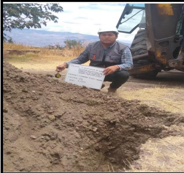
Se realizó la excavación y extracción de la primera muestra de la calicata N° 01, realizado en el kilómetro 6+020.
