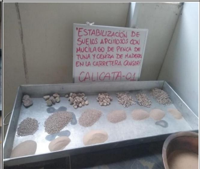
Obtención del material según las medidas de los tamices, donde cada material tiene su peso indicado para poder realizar la curva granulométrica y así identificar según la norma ASHTO Y SUCS.
