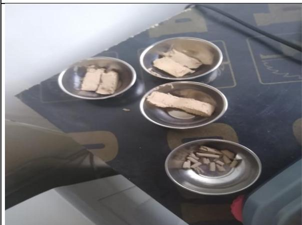
Se realiza una mezcla del material seleccionado con adición de líquido moderadamente calculado para poder hacer 2 muestras, se realiza de manera cilíndrica de 3.2 mm (un parecido de una mina de un lapicero). Luego llevarlo al horno para su secado y obtener la cantidad de líquido que se incorporó. Y así obtener su límite plástico.
