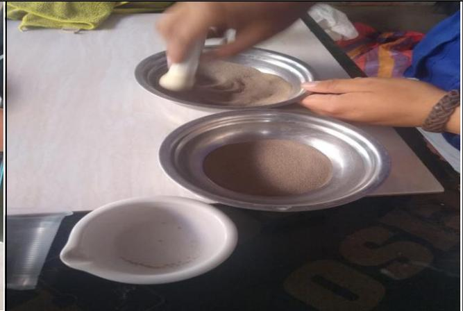
Para el límite de consistencia se realiza una tamizada con la malla N° 40 para obtener 100g de para el límite líquido y 20g para el limite plástico.
