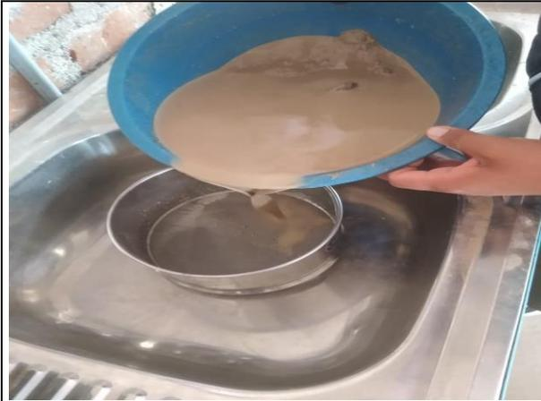
Se realiza un lavado del material con la finalidad de desechar todo el limo que tiene el material, después de ello llevar al horno para un secado.
