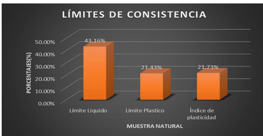
*Figura N°10 : Grafico del limite de consistencia de la muestra natural.*
