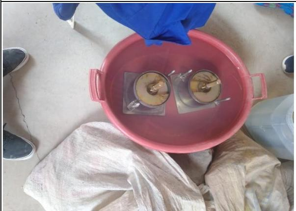
El CBR se realiza después de hacer el proctor modificado y esta debe estar sumergido en agua durante 4 días para poder calcular su Resistencia. La prueba se realiza con un equipo que tiene un pistón en el medio, prácticamente una prensa, donde se tiene que girar de acuerdo a un cronómetro y poder ver su comportamiento. En total se realiza 3 pruebas y son variables dependiendo a los golpes que se dio en el proctor modificado.
