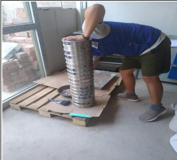
Al realizar el ensayo granulométrico, lo primero se realizó el tamizado del material arcilloso en las mallas que es desde la medida de 3" hasta la malla N°200.
