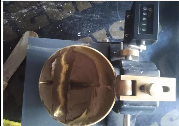
Una vez que se tiene la cantidad requerida de la muestra, se tiene que agregar líquido de manera controlada, la finalidad es buscar una cantidad para que pueda cumplir en el ensayo de Casagrande y hallar el limite líquido. En total se realiza 3 muestras: 15-25 g; 20-30; 25-35. (golpes).
