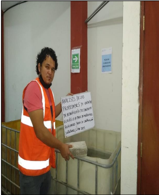
Imagen: Curado del ladrillo de concreto ecológico. Fuente: Elaboración propia,2021.
