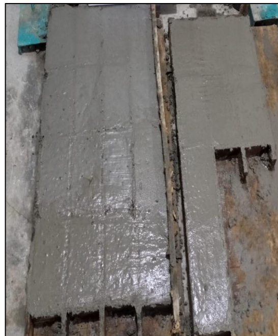
Imagen: Vaciado del ladrillo de concreto ecológico. Fuente: Elaboración propia,2021.
