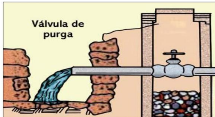
Fig. N° 12 – valvula de purga
