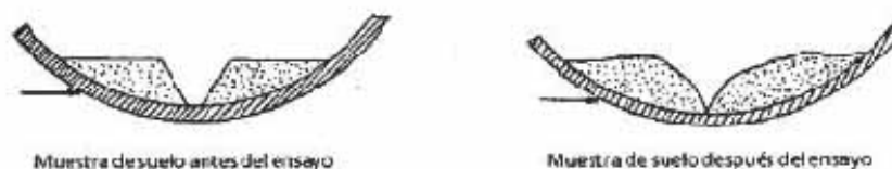
Figura 15. Diagrama Ilustrativo del Ensayo de Límite Líquido
