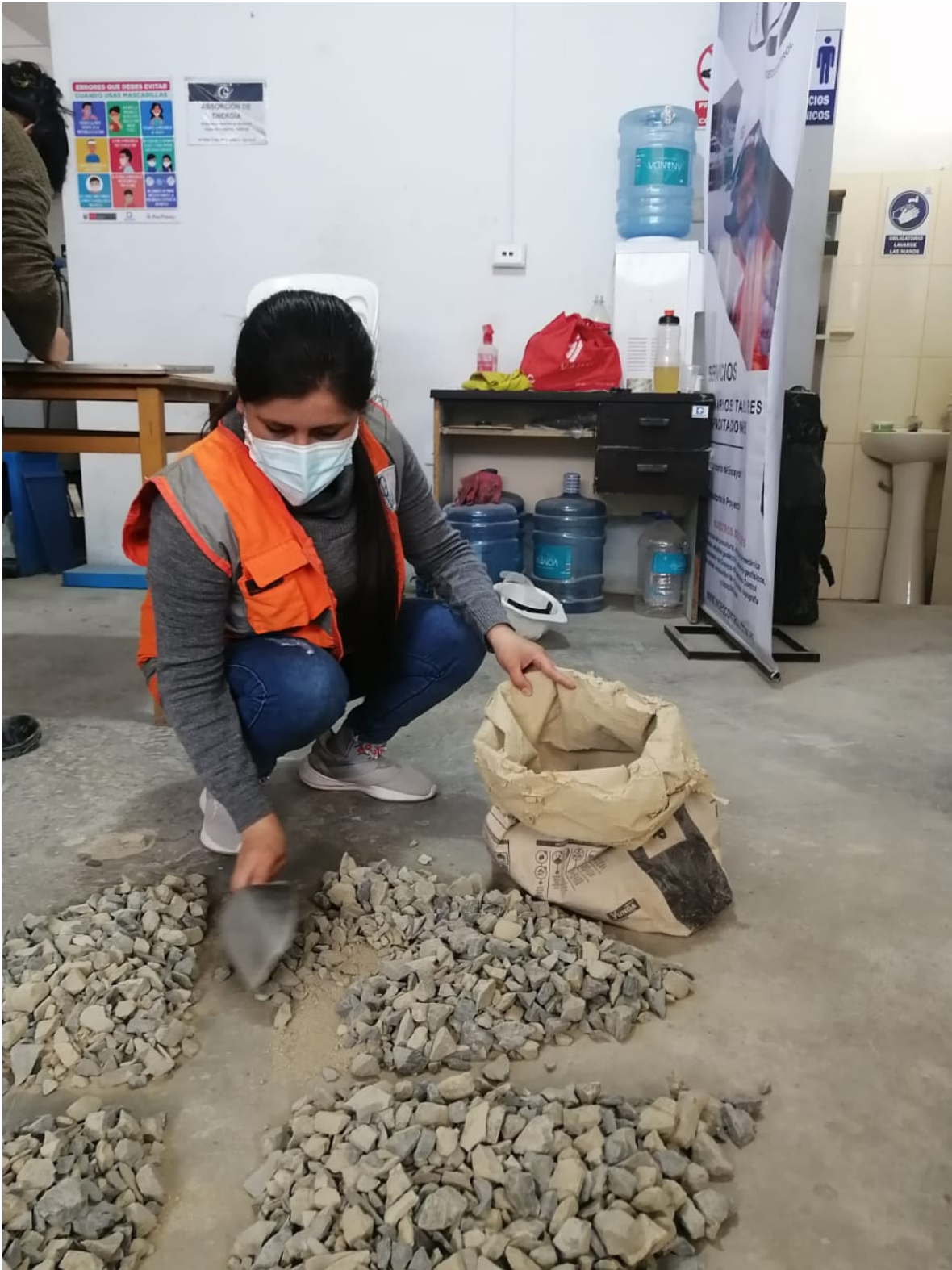
Muestreo y cuarteo de agregados. Fuente: Elaboración Propia.
