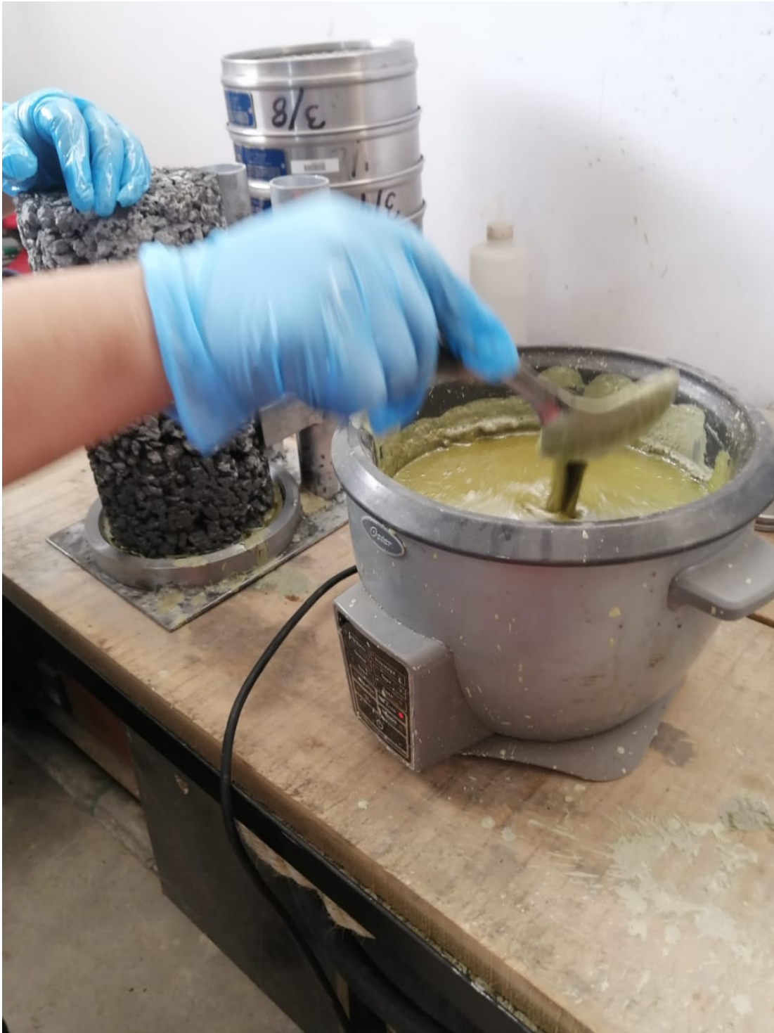
Preparación del azufre para el capeo de probetas cilíndricas. Fuente: Elaboración Propia.
