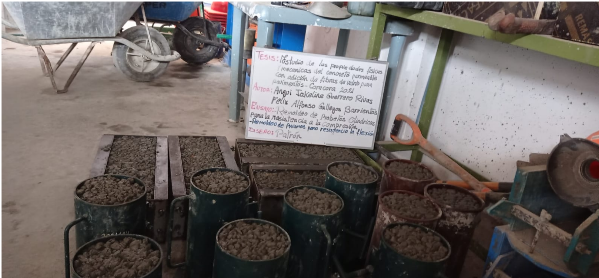
Remoldeo de probetas cilíndricas y remoldeo de Vigas diseño patrón. Fuente: Elaboración Propia.
