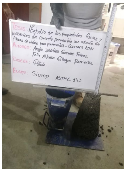
Figura 21. Ensayo de consistencia realizado. Fuente: Elaboración Propia
