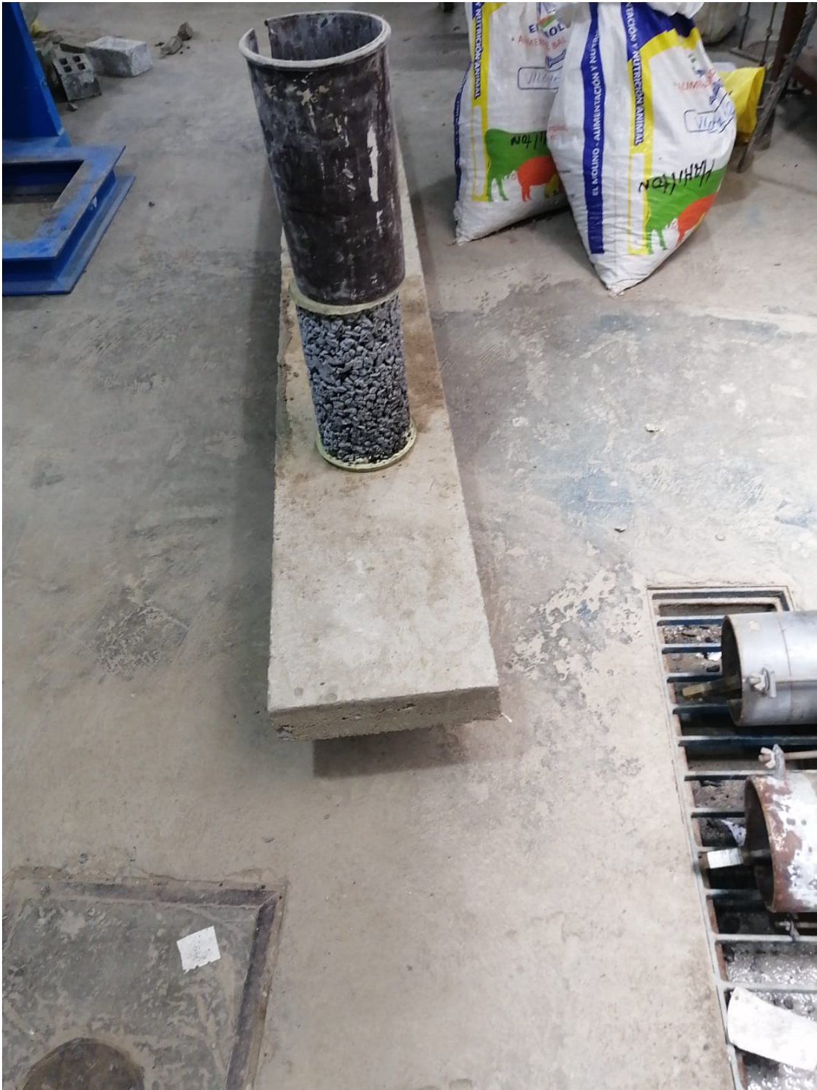
Probeta cilíndrica capeada , antes de ser comprimida. Fuente: Elaboración Propia.
