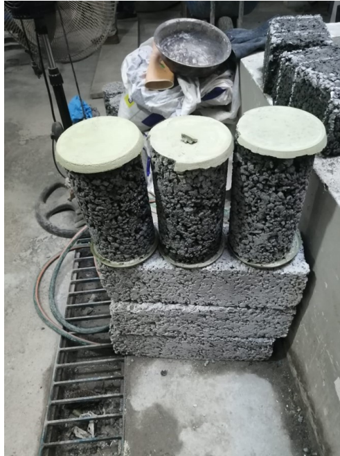
Figura 25. Probetas capeadas patrón después del ensayo de compresión. Fuente: Elaboración propia.
