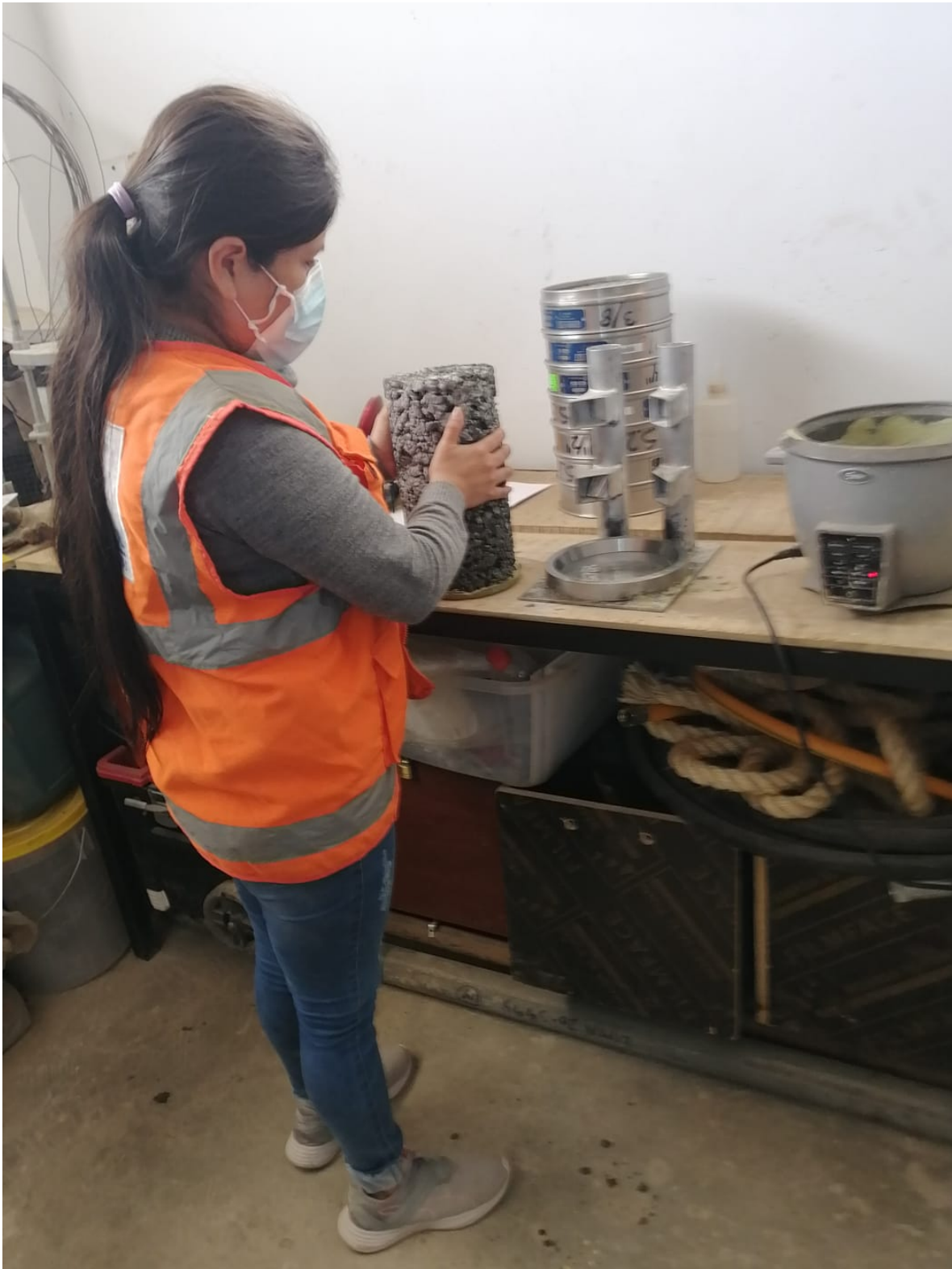
Realizando el capeo a la probeta cilíndrica. Fuente: Elaboración Propia.
