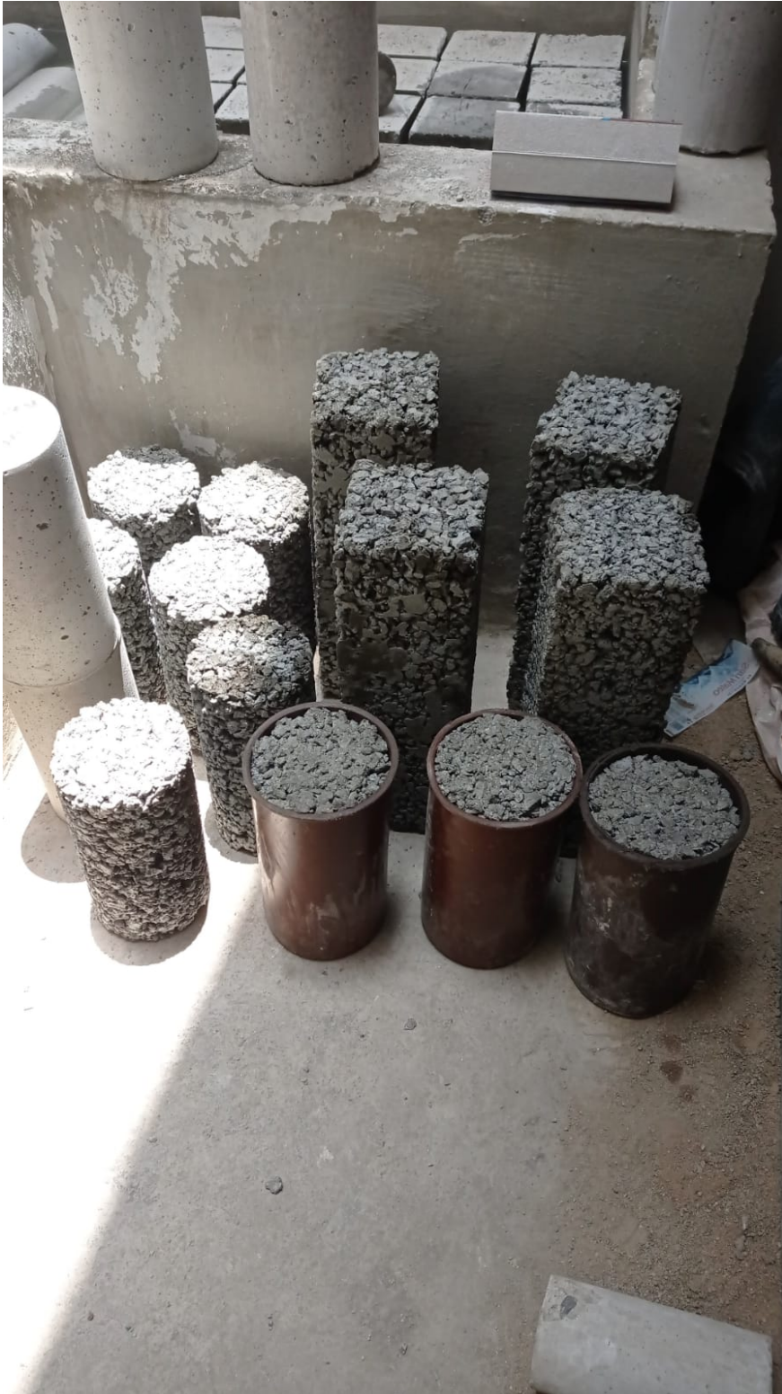
Elaboración de probetas y vigas de concreto permeable. Fuente: Elaboración Propia.
