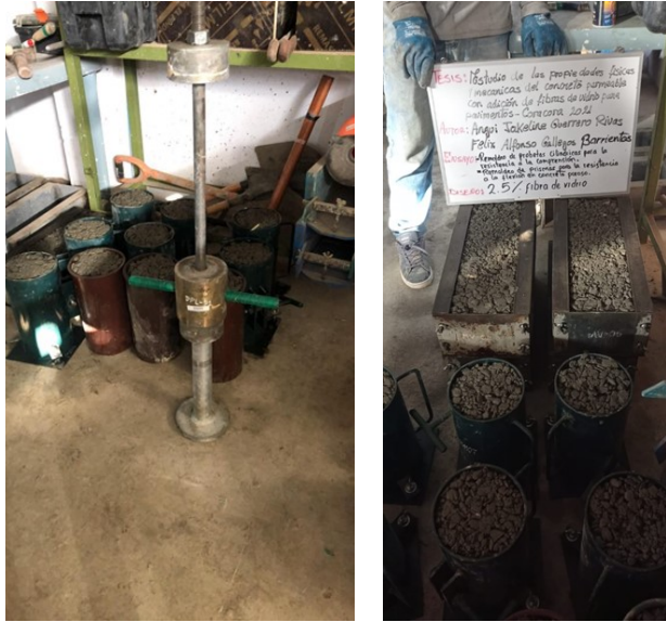
Figura 22. Moldeo de probetas cilíndricas y prismáticas. Fuente: Elaboración Propia
