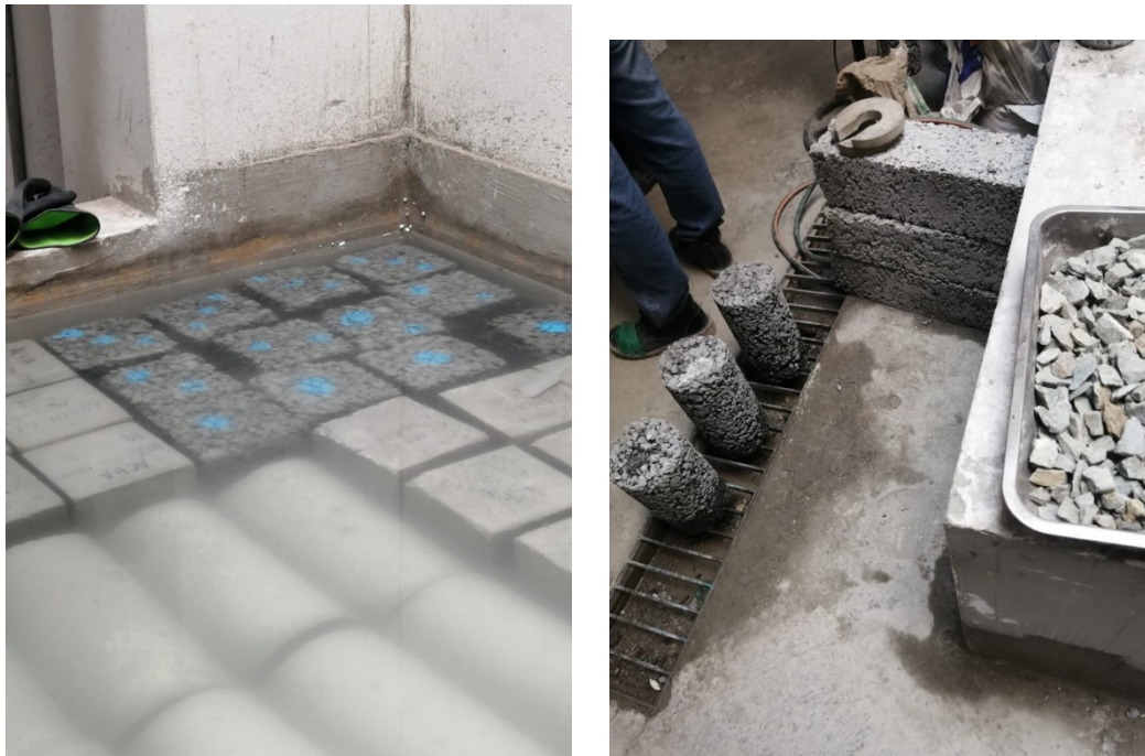
Figura 23. Curado de probetas cilíndricas y prismáticas. Fuente: Elaboración Propia
