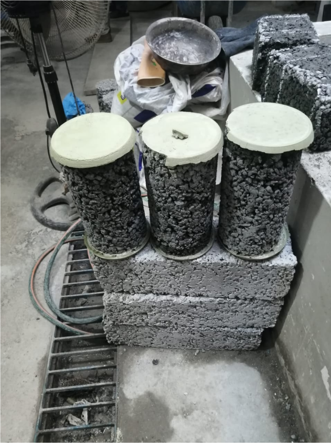
Probetas capeadas patrón después del ensayo de compresión.. Fuente: Elaboración Propia.
