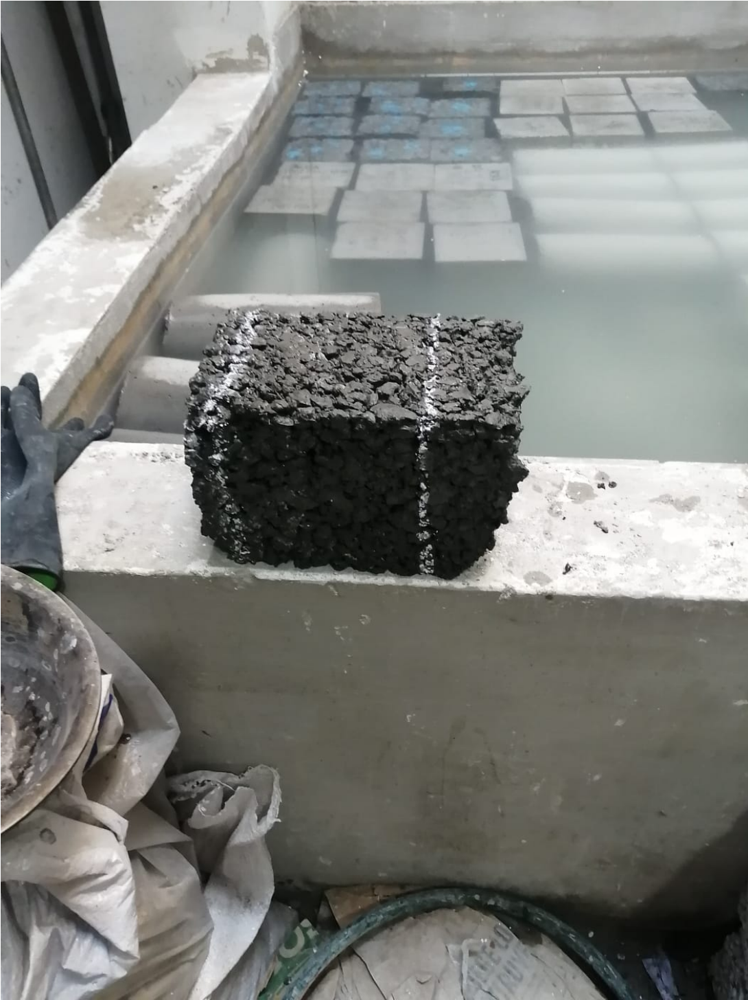
°: ...Vigas después del ensayo de flexión. Fuente: Elaboración Propia.
