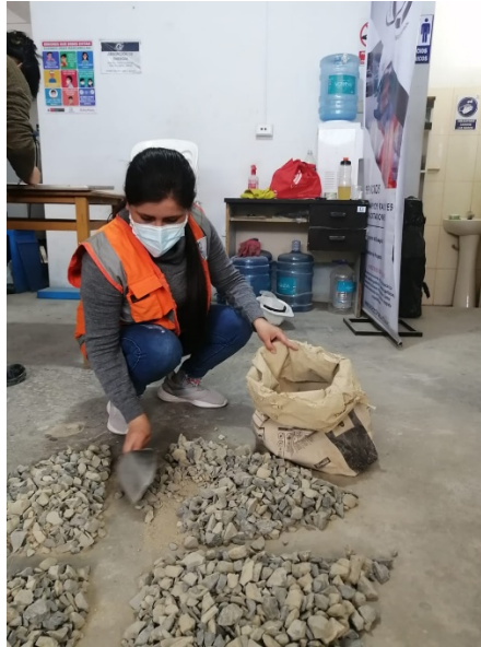
Figura 16. Cuarteo de agregados. Fuente: Elaboración Propia
