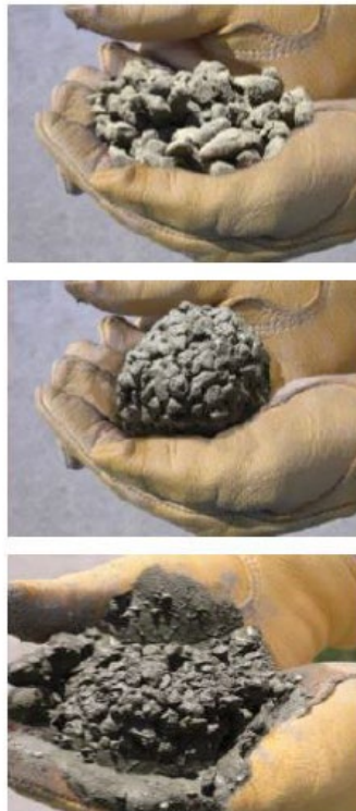
Figura 4. Ejemplos de concreto permeables con diferentes contenidos de agua, formados en una pelota: a) Muy poca agua, b) Cantidad de agua adecuada, c) Mucha agua. Fuente: Pervious Concrete Pavements (Paul D. Tennis).
