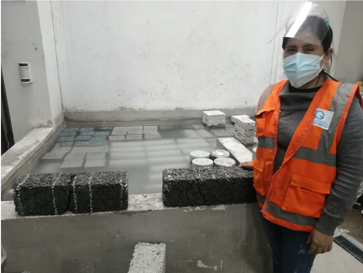
Vigas después del ensayo de flexión. Fuente: Elaboración Propia.
