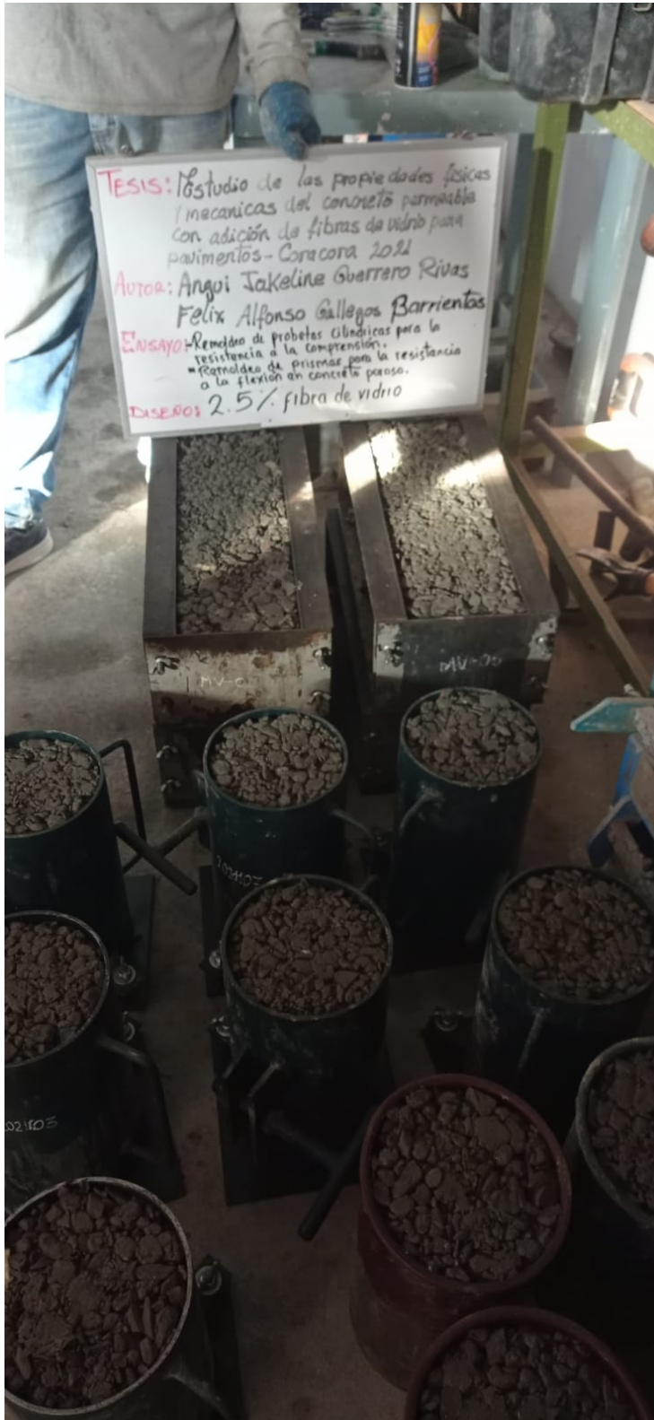
Remoldeo de probetas cilíndricas y remoldeo de Vigas con 2.5% de fibra de vidrio. Fuente: Elaboración Propia.
