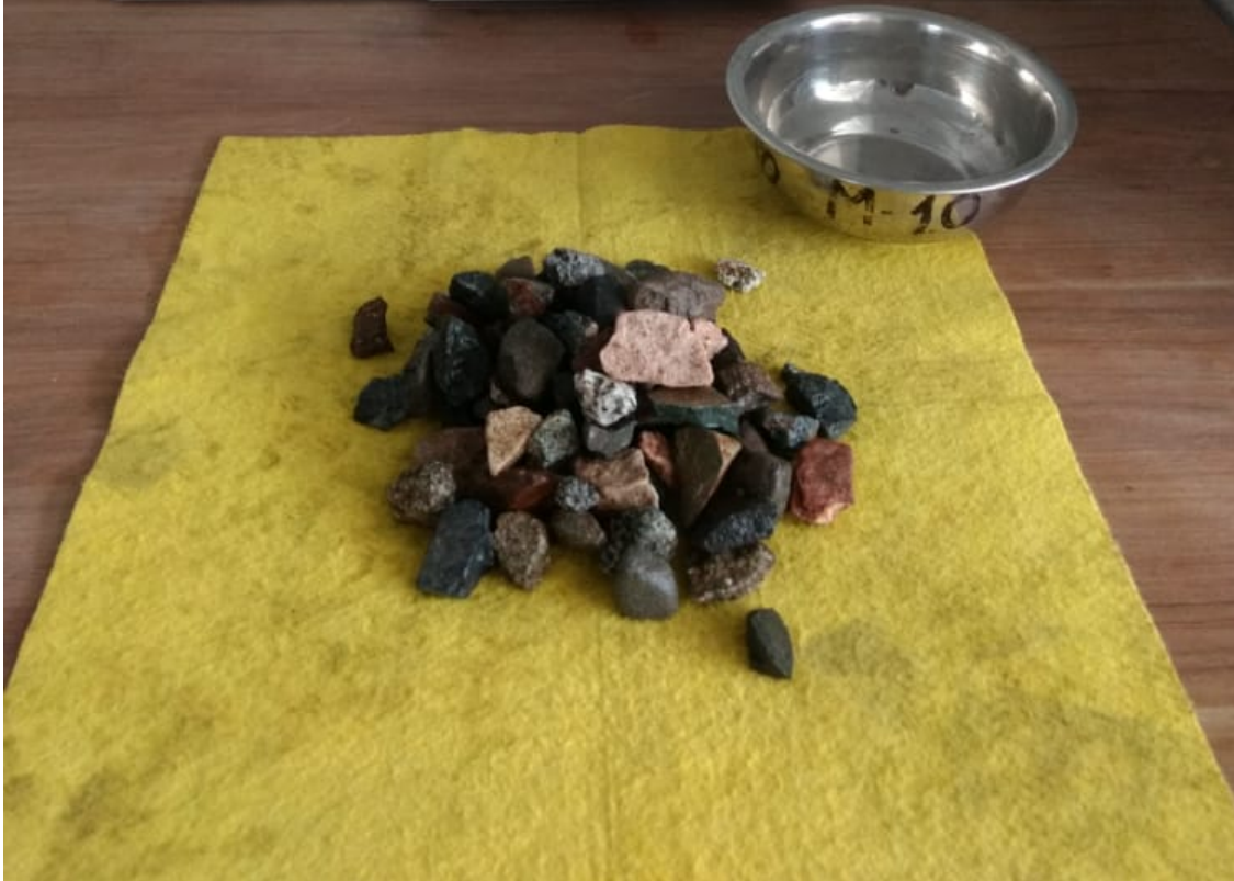
Método de pruebas estándar para determinar la densidad relativa y la adsorción de los agregados. Fuente: Elaboración Propia.
