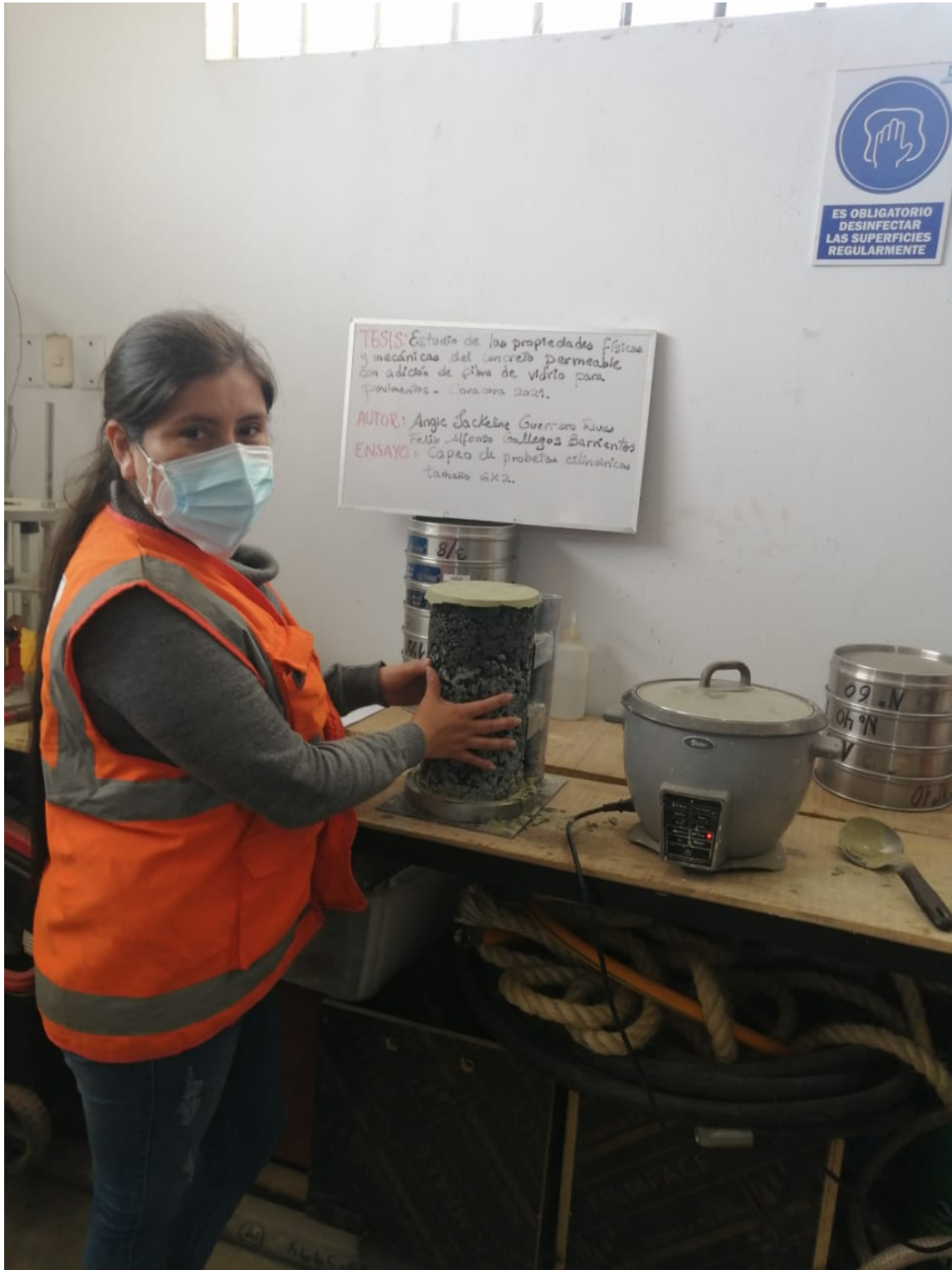
Capeo de probetas cilíndricas.. Fuente: Elaboración Propia.
