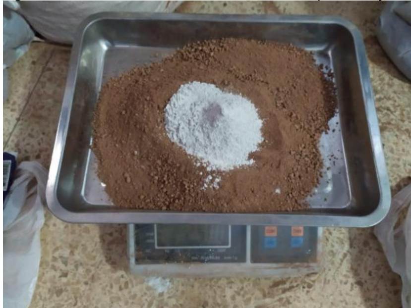
Figura 4.24. Peso del Suelo natural más porcentaje de Cal
