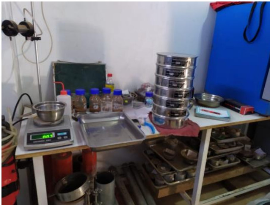
Figura N° 07: trabajos de laboratorio granulometría.
