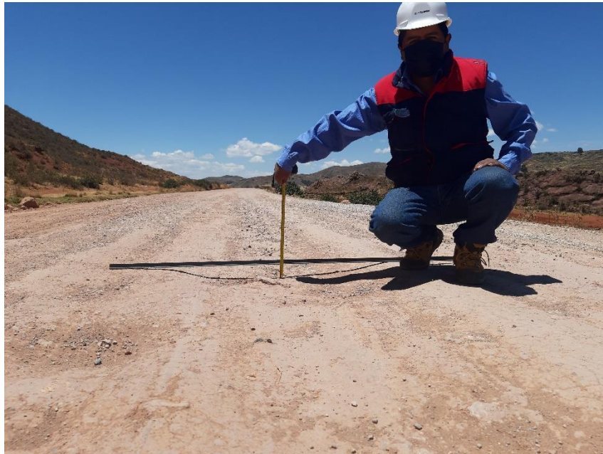
Figura N° 01: trabajos de campo medidas de ahuellamiento.
