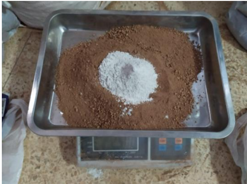
Figura N° 12: trabajos de laboratorio Incorporando Cal.
