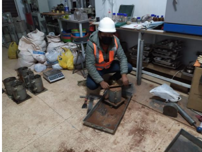
Figura 4.9. Ensayo de CBR subrasante del suelo natural
