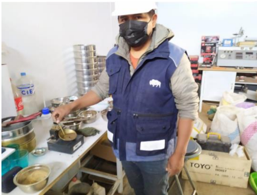
Figura N° 08: trabajos de laboratorio Limite Liquido.
