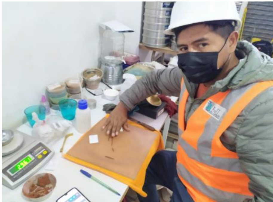
Figura N° 09: trabajos de laboratorio Limite Plastico
