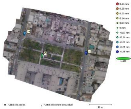
Fig. 4. Posiciones de puntos de apoyo y estimaciones de errores. El color indica el error en Z mientras el tamaño y forma de la elipse representan el error en XY.
