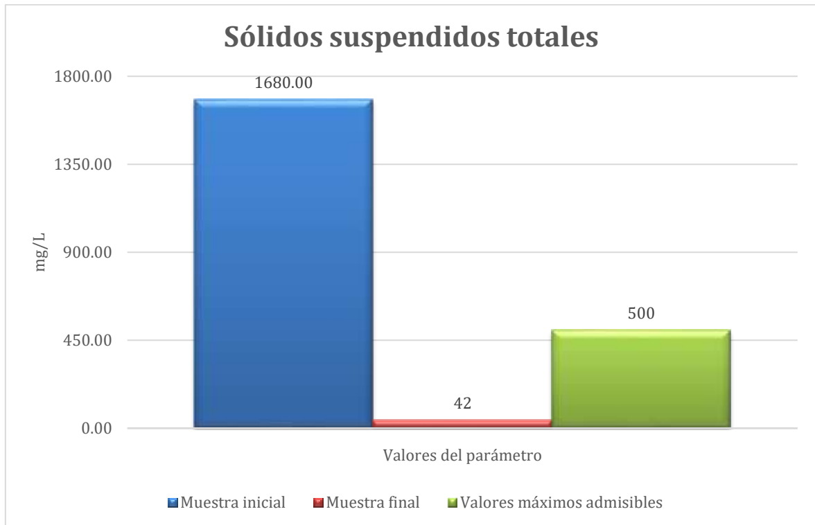
Figura 31. Valores inicial y final del parámetro sólidos suspendidos totales vs su valor máximo admisible
