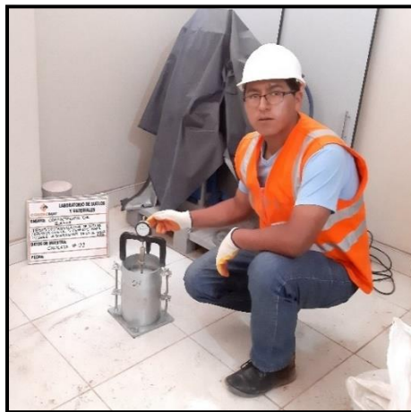
Figura 54. Registro de la expansión del suelo posterior a los 4 días de sumergido. Fuente: Elaboración propia.
