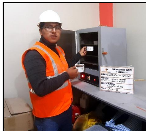
Figura 38. Secado de la muestra en el horno. Fuente: Elaboración propia.
