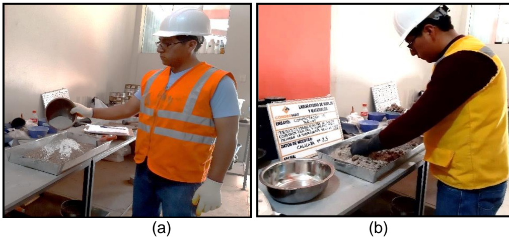
Figura 48. (a) Incorporación de la cal y cemento a la muestra. (b) Proceso de homogenización de la muestra. Fuente: Elaboración propia.
