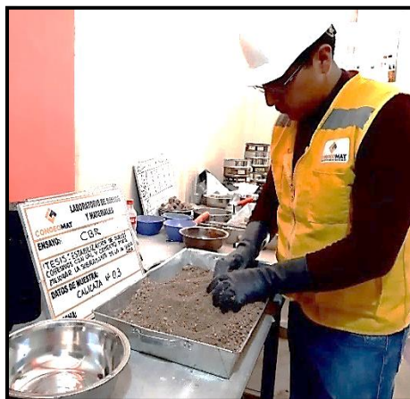
Figura 52. Homogenización de la muestra + cal + cemento proporcionalmente. Fuente: Elaboración propia.
