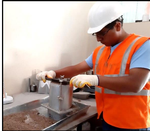
Figura 50. Enrazado de la muestra compactada. Fuente: Elaboración propia.
