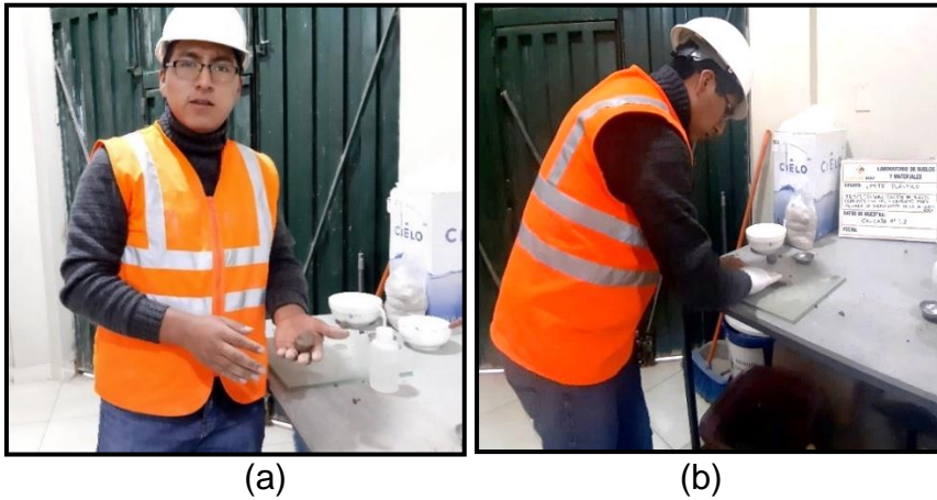
Figura 43. (a) Moldeo de la muestra en forma esférica. (b) Prueba de plasticidad de la muestra. Fuente: Elaboración propia.
