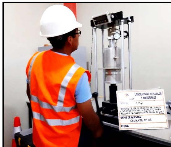
Figura 55. Lectura de la penetración del suelo con el equipo CBR. Fuente: Elaboración propia.
