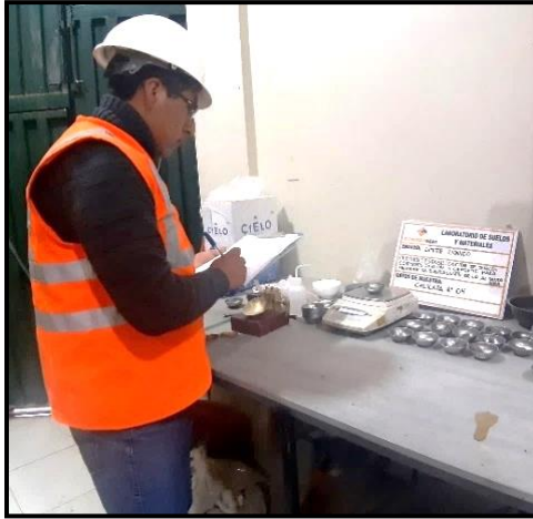
Figura 42. Registro del peso húmedo extraída de la cuchara de Casagrande. Fuente: Elaboración propia.
