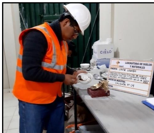
Figura 41. Procedimiento del Límite Líquido en la cuchara de Casagrande. Fuente: Elaboración propia.
