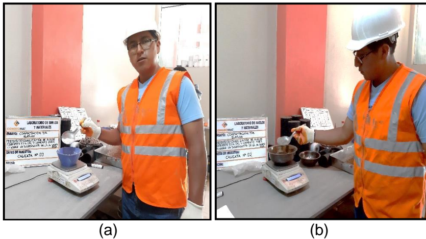
Figura 47. (a) Registro del peso de cal requerido. (b) Registro del peso de cemento requerido. Fuente: Elaboración propia.
