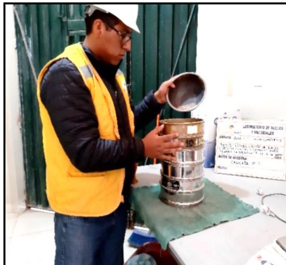
Figura 46. Procedimiento del tamizado de la muestra. Fuente: Elaboración propia.
