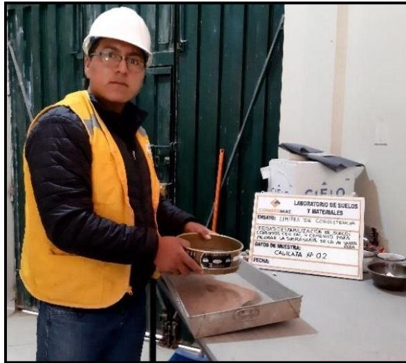
Figura 39. Obtención de la muestra por el tamiz N°40. Fuente: Elaboración propia.
