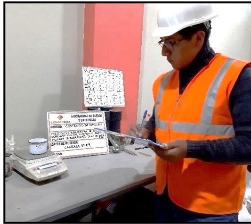
Figura 37. Registro del peso húmedo del suelo. Fuente: Elaboración propia.
