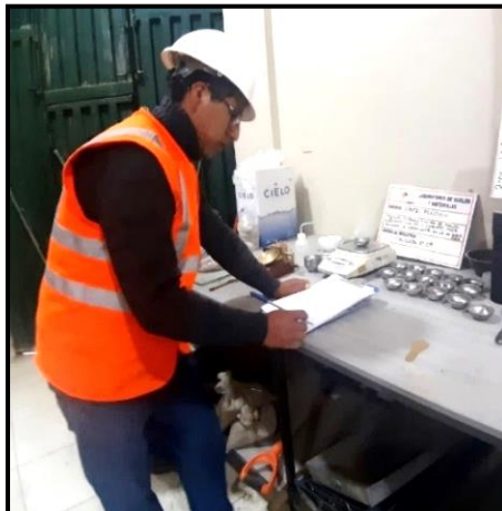
Figura 44. Registro del peso húmedo de los ensayo del límite líquido y del límite plástico. Fuente: Elaboración propia.
