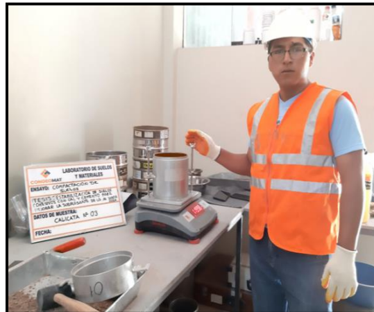
Figura 51. Registro del peso húmedo de la muestra compactada. Fuente: Elaboración propia.
