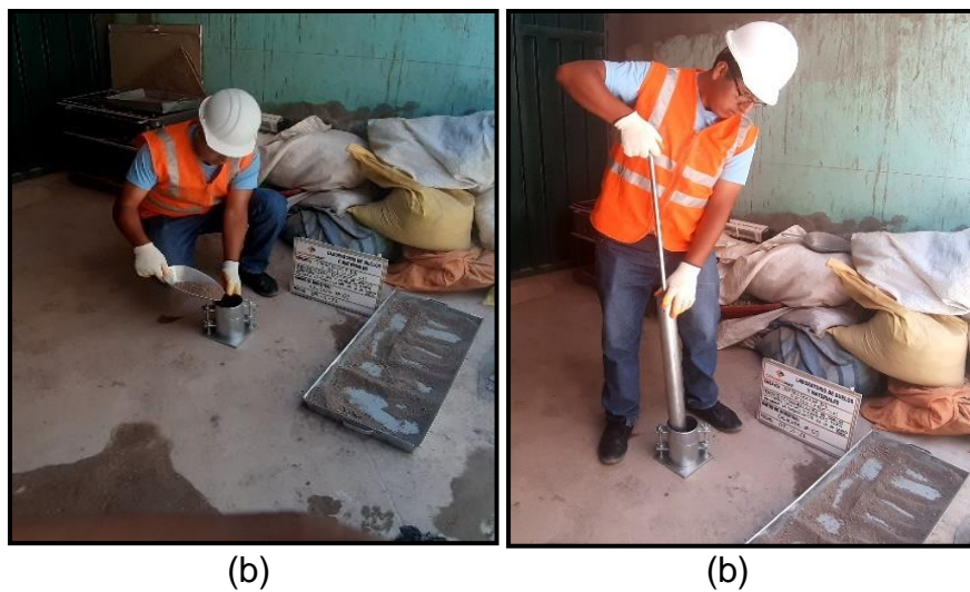
Figura 49. (a) Llenado de la muestra en el molde proctor. (b) Compactación de la muestra en 5 capas. Fuente: Elaboración propia.
