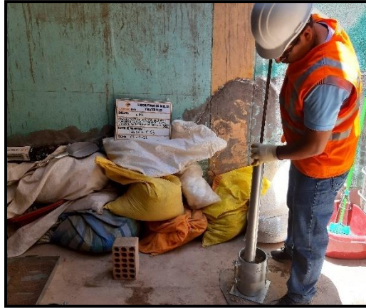
Figura 53. Proceso de compactación de la muestra homogenizada. Fuente: Elaboración propia.
