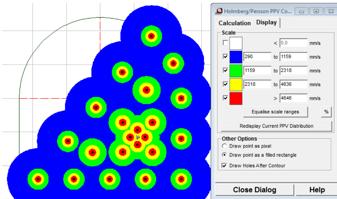
Ilustración 18. Simulación del PPV de la primera voladura en el software JK Simblast - 2D Bench
