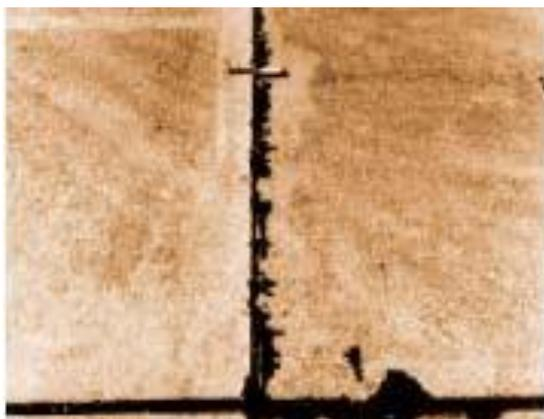
FIG. X2.24 Fallas de baja severidad
