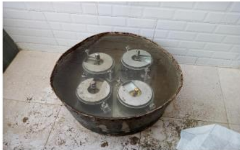
Fotografía 44: Ingreso de los moldes de CBR al agua por un tiempo de 4 días
