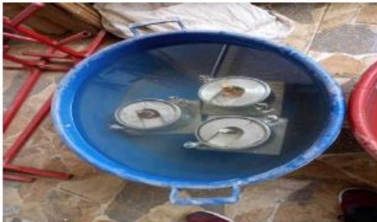
Fotografía 42: Ingreso de los moldes de CBR al agua por un tiempo de 4 días
