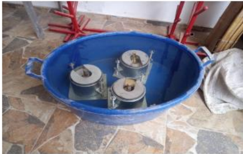
Fotografía 20: Ingreso de los moldes de CBR al agua por un tiempo de 4 días para la C-2
