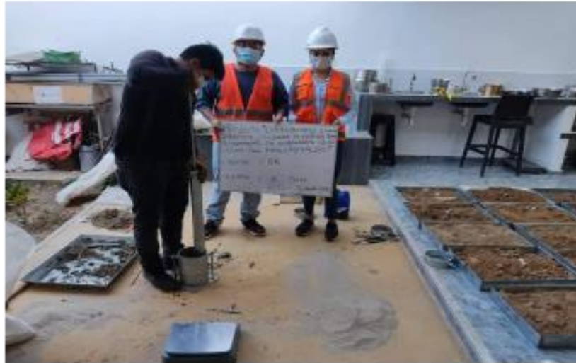
Fotografía 19: Realizando el ensayo de CBR para la calicata 2
