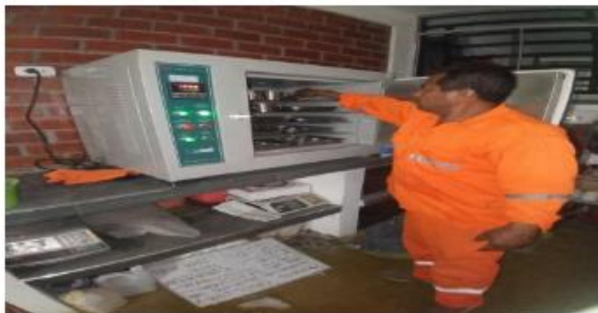
Fotografía 11: Secado del material a 110°C
