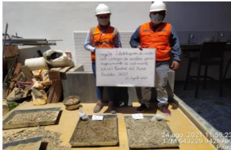
Fotografía 8: colocación de las muestras de ambas calicatas en bandejas, la cual se dejó secar 24h.
