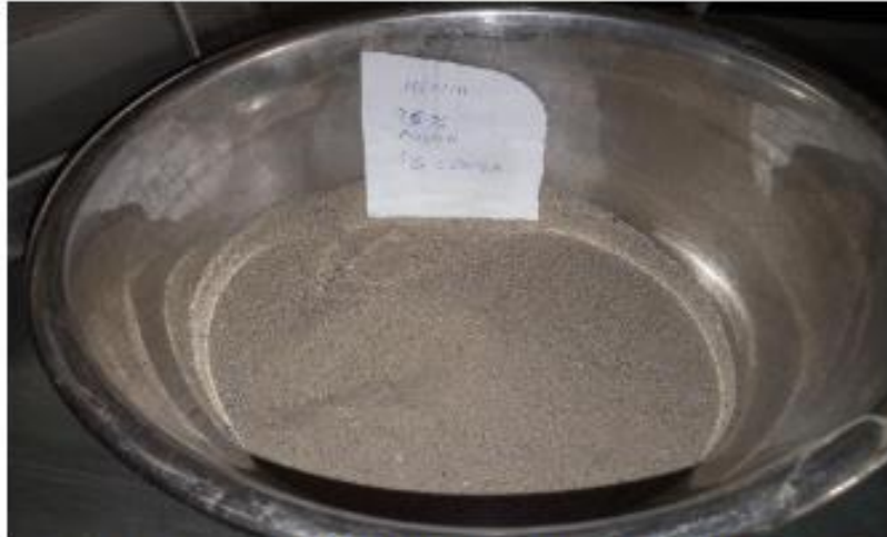
Fotografia 23: Mezcla con el diseño del 95% arena + 5% de cenizas de carbon
