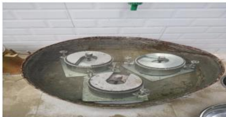
Fotografía 18: Ingreso de los moldes de CBR al agua por un tiempo de 4 días para la C-1
