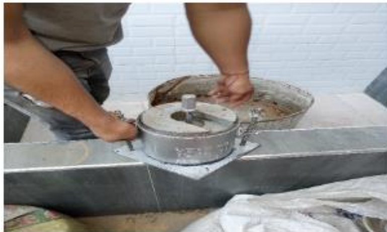
Fotografía 46: Ingreso de los moldes de CBR al agua por un tiempo de 4 días
