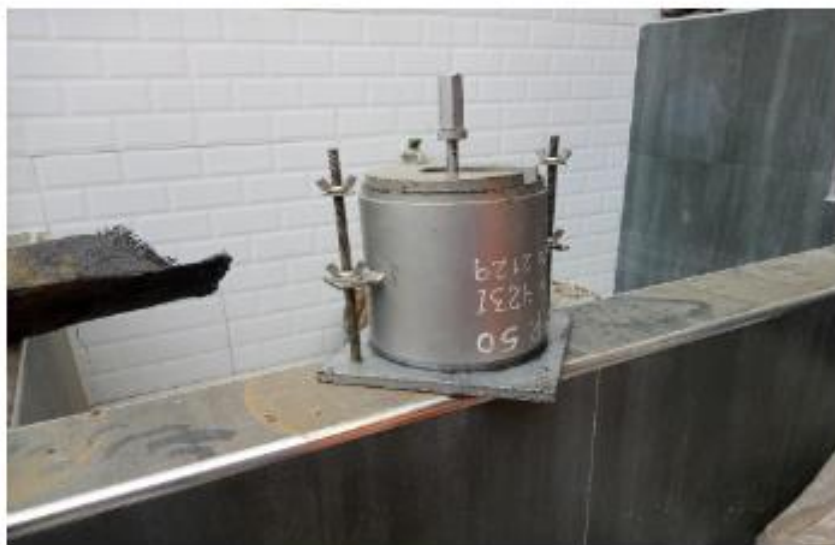
Fotografía 48: Ingreso de los moldes de CBR al agua por un tiempo de 4 días
