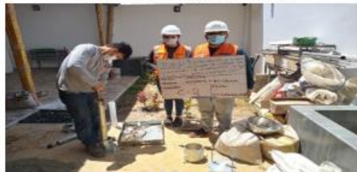
Fotografía 39: Realizando el ensayo de proctor modificado con el diseño de 90% arena + 10% de cenizas de carbon
