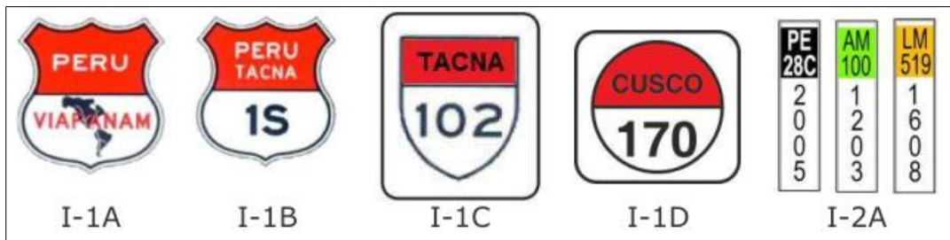
Ilustración 4.8.7 – Señales informativas de identificación
