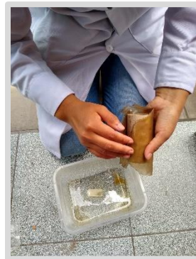
Elaboración de la bolsa de bioplástico
