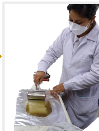
Vertimiento de la mezcla al aluminio
