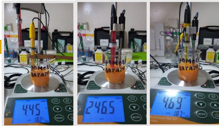
Análisis químico: pH, Potencial redox y conductividad eléctrica.
