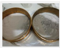
Análisis Físico: tamaño de partícula (granulometría)
