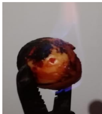
Figura 13. Encendido de la biomasa
