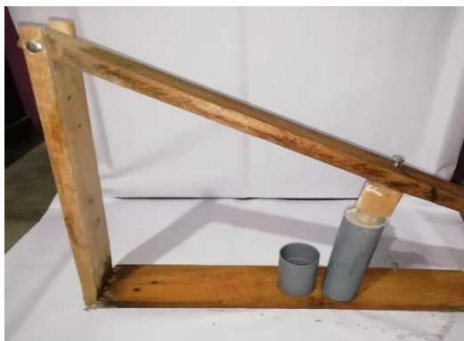
Figura 7. Prensa briquetadora elaborada manualmente
