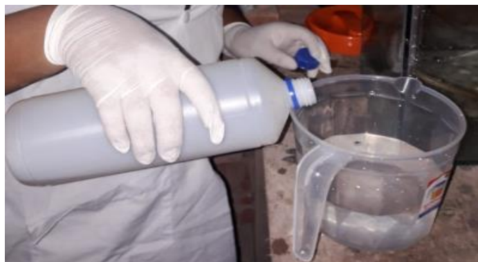
Figura 11. Vertimiento 1.5L de lodo activado a cada recipiente
