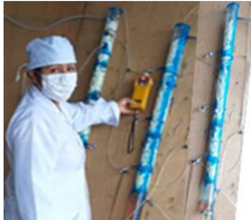
Figura 15. Proceso de operación del sistema de biofiltro percolador
