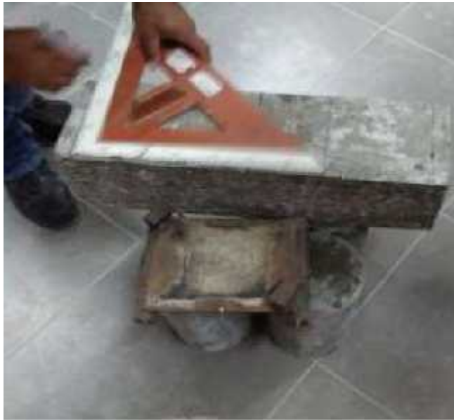
fotografía 31: medida de viga para ensayo
