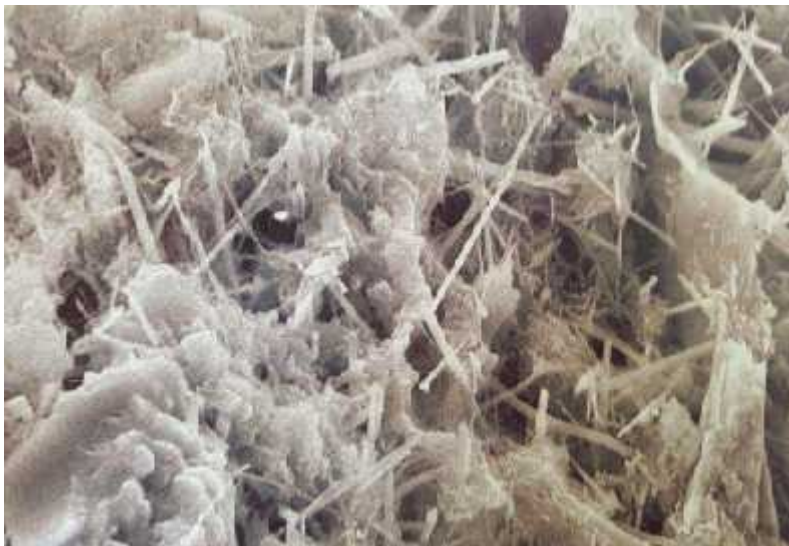
Fotografía 14: fotografía microscópica de eflorescencia con mortero.
