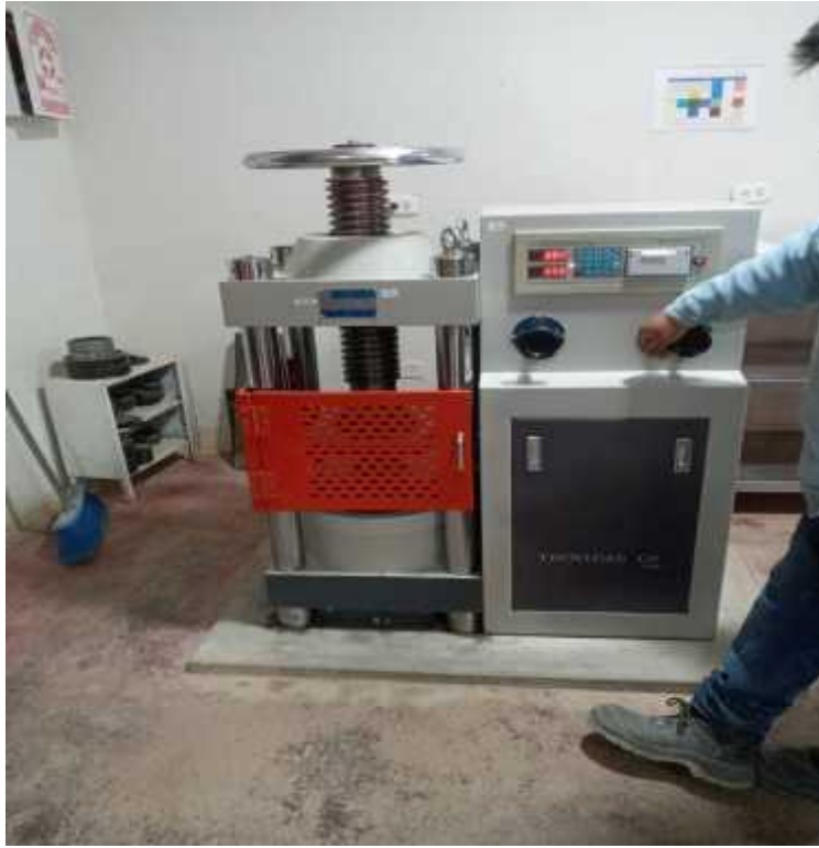
15) Ensayo a compresión de dados
