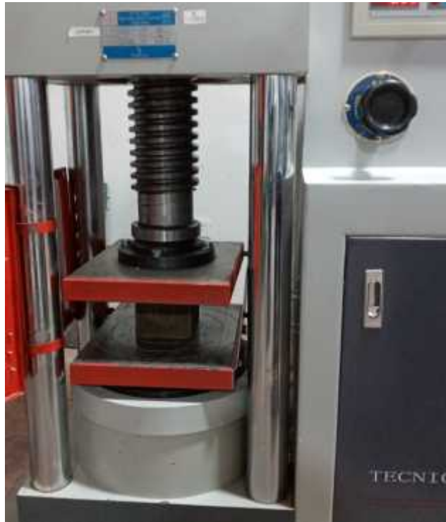
fotografía 30: ensayo de compresión a dados de concreto
