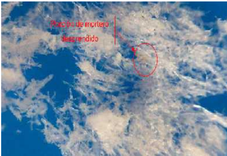
Fotografía 13: muestra de eflorescencia con porción de mortero
