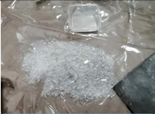
Foto 01 Vidrio Borosilicato en proceso de trituración
