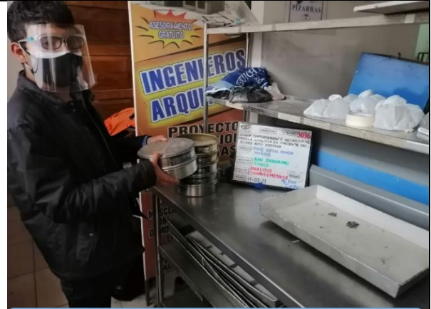
Foto 02 Tamizado de agregado para dosificación
