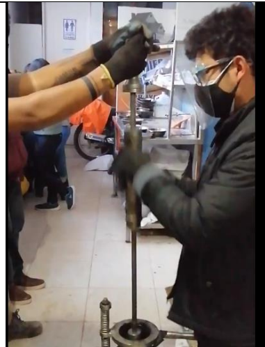
Foto 04 Golpes con Apisonador sobre probetas
