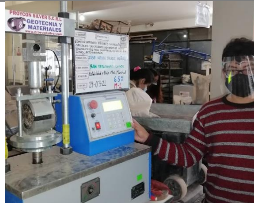
Foto 06 Prensa Marshall Estabilidad y Flujo
