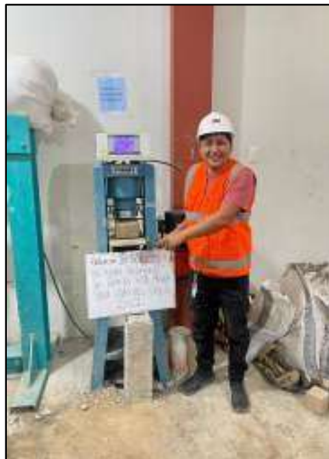
Figura 23. Ensayo de flexión del adobe Fuente: Elaboración propia
