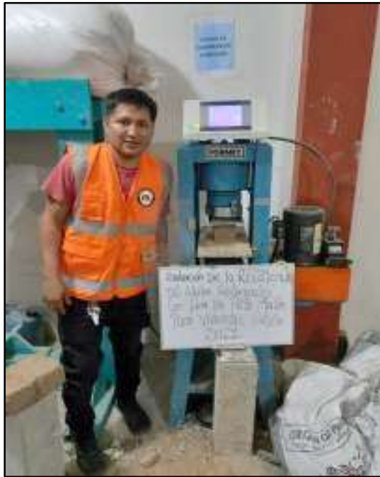
Figura 24. Ensayo de compresión del adobe Fuente: Elaboración propia
