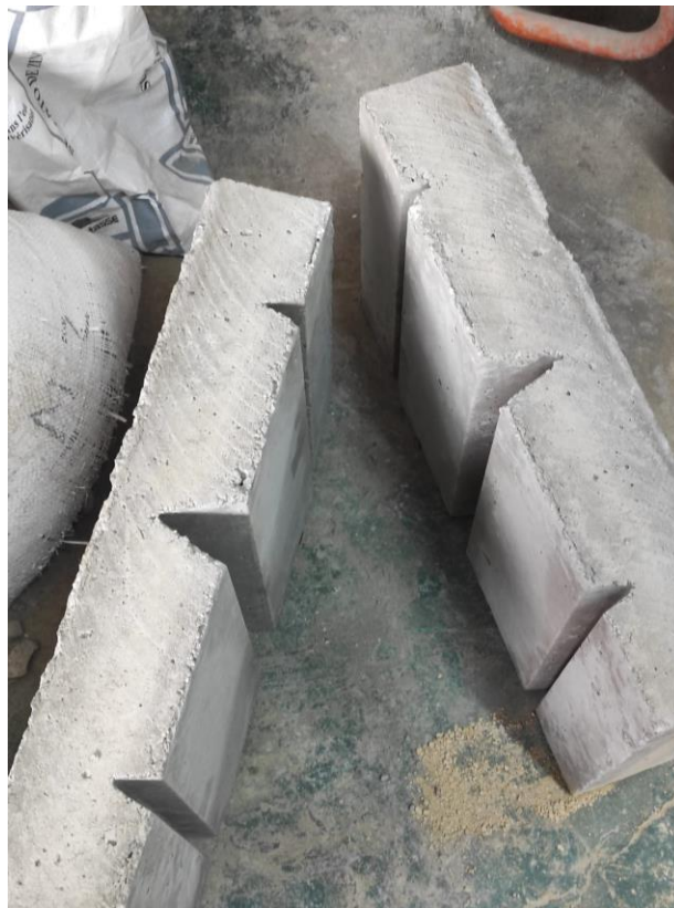
Figura 22: Paneles de concreto
