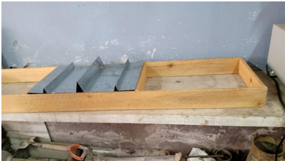
Figura 19: Equipos para el ensayo de retracción plástica
