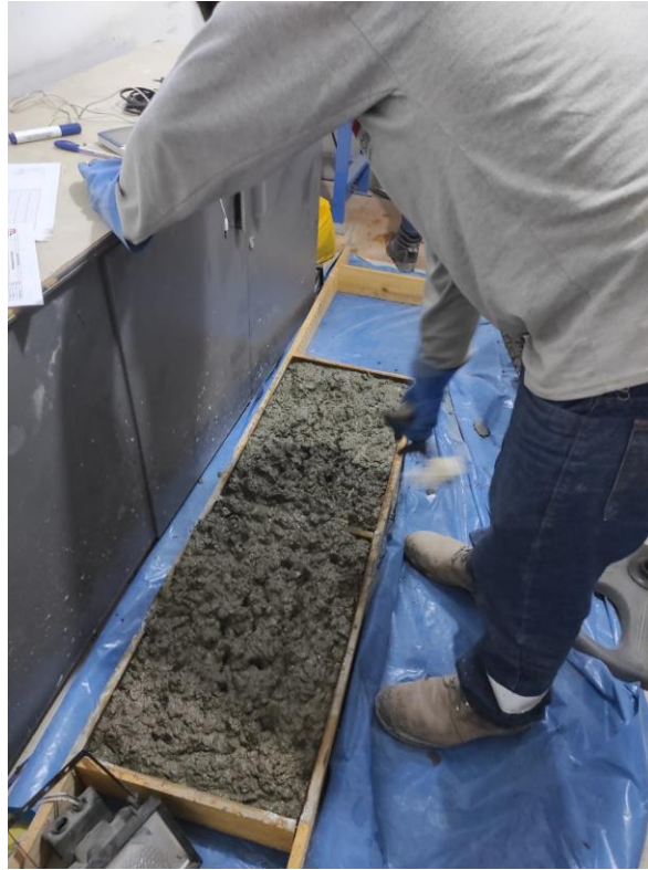
Figura 21: Vaciado de concreto en los paneles de concreto
