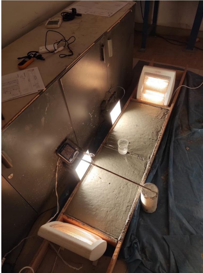
Figura 20: Cámara de ambiente
