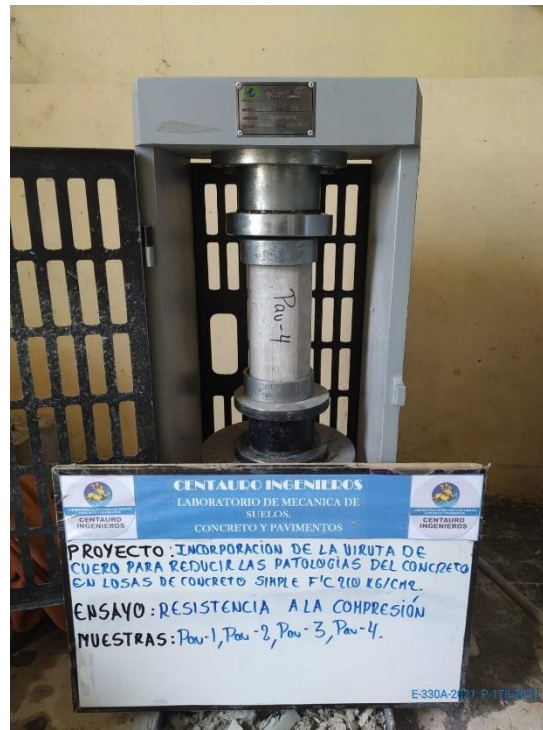
Figura 23: Rotura de probetas para determinar la resistencia a la compresión
