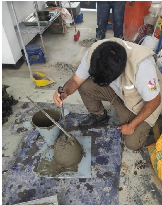
Figura 6: Ensayo de asentamiento
